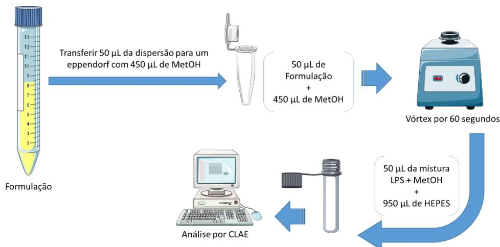
**Figura 7.** Representação do protocolo utilizado para a determinação do fármaco total nas formulações avaliadas. Ilustração do autor.
