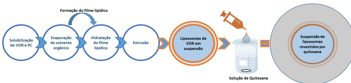
**Figura 6.** Representação esquemática do processo de obtenção dos nanossistemas de lipossomas de VOR revestidos por quitosana. Ilustração do autor.
