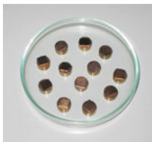
Figura 3.15 – Amostras de geomembranas preparadas para serem digitalizadas no MEV.
