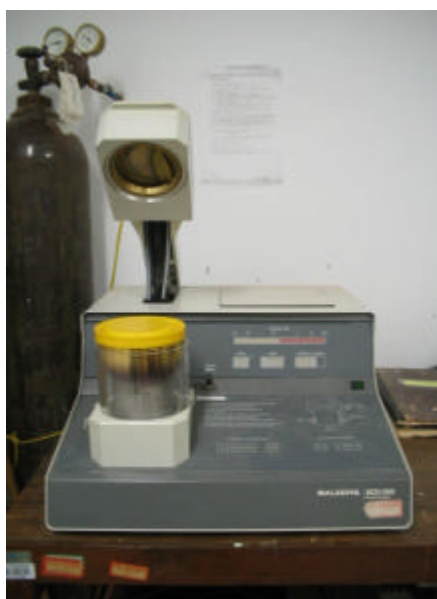
Figura 3.16 – Equipamento que proporciona a metalização das amostras.
