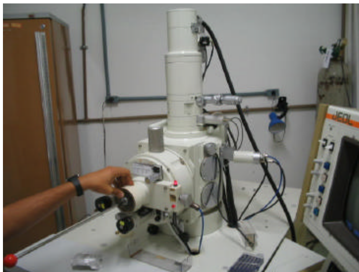
Figura 3.14 – Amostra sendo introduzida no Microscópio Eletrônico de Varredura (MEV).
