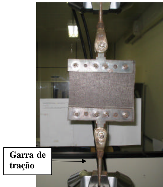
Figura 3.3- Amostra de geotêxtil no início do ensaio de RTS.
