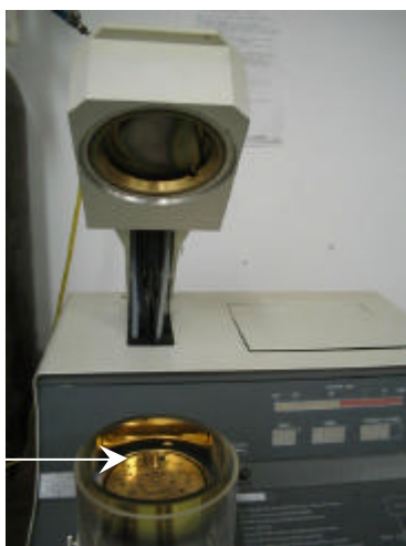
Figura 3.17 – Detalhe do equipamento onde as amostras metalizadas com o ouro.
