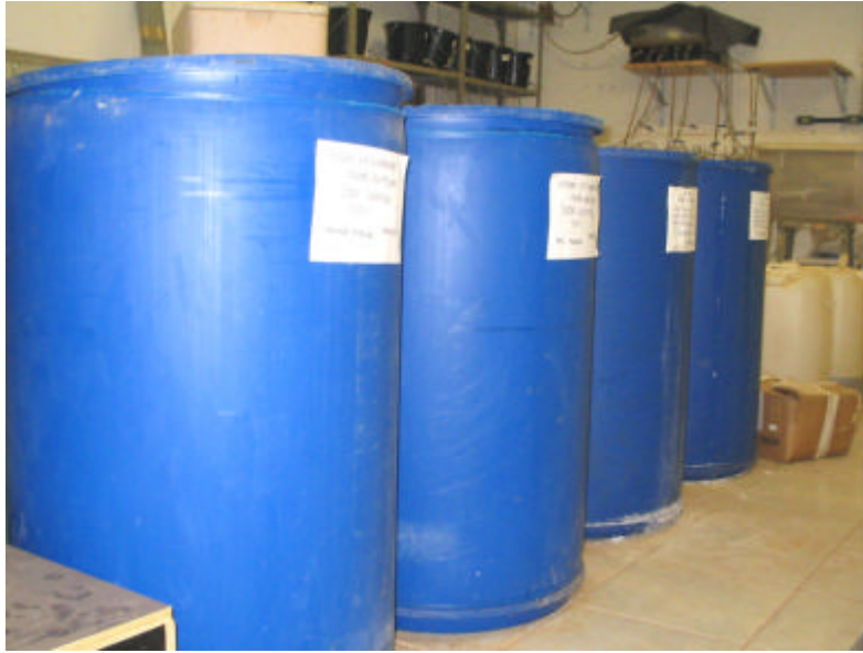
Figura 3.1-Recipientes com os fluidos agressivos nos quais foram imersos os geossintéticos.
