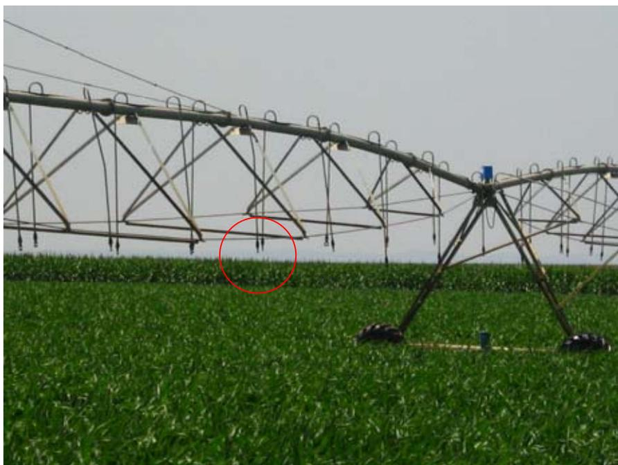
Figura 23 – Pivô central com haste para irrigação localizada.
