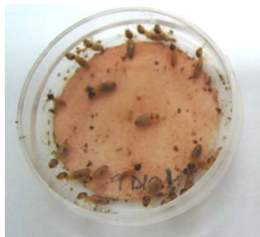
Figura 35 – Disco de celulose tratado com o extrato acetato de etila do cerne interno de O. flava , após 72 horas de contato direto com os operários da espécie Nasutitermes macrocephalus .
