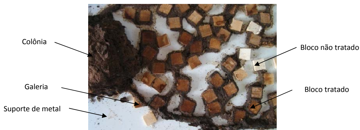
Figura 49 – Blocos expostos ao ataque de cupins.
