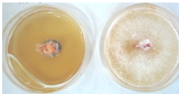
Figura 33 – Placa de Petri teste contendo o extrato acetato de etila da madeira de S. rubra na concentração de 250 \mu\text{g}\cdot\text{ml}^{-1} (à esquerda) e o controle negativo (à direita).
