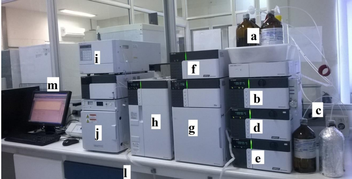
Figura 10. Sistema cromatográfico Shimadzu® do Laboratório de Toxicologia: a) reservatório da fase móvel; b) bomba de alta pressão; c) soluções de derivatização pós coluna; d) bomba de alta pressão; e) bomba de alta pressão; f) módulo comunicador; g) injetor; h) coluna; i) detector; j) caixa de reação química; l) resíduos e m) Software.
