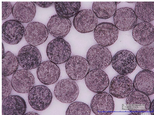
Figura 10 – Microfotografia de grãos de pólvora de uma munição CBC 9mm Gold .
