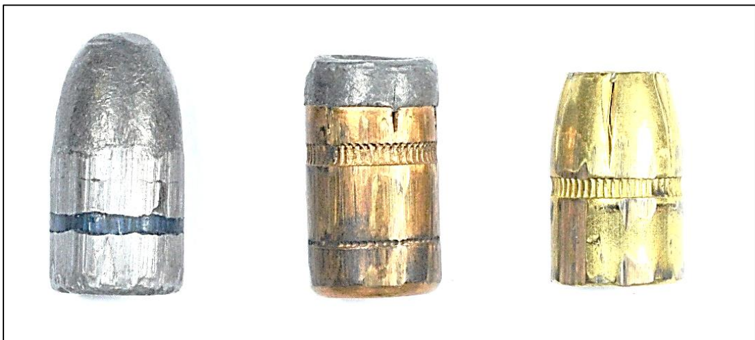
Figura 11 – Fotografia de três projéteis de munição calibre .38SPL, da esquerda para direita, de liga de chumbo, semiencamisado e encamisado.
