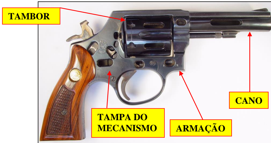
Figura 5 – Fotografia identificando partes de um revólver.
