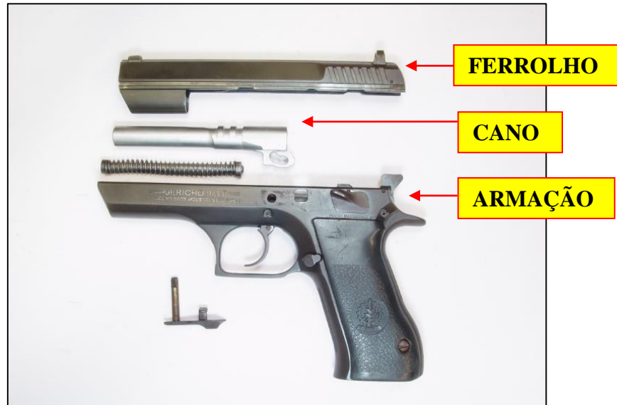
Figura 7 – Fotografia identificando principais partes de uma pistola desmontada.
