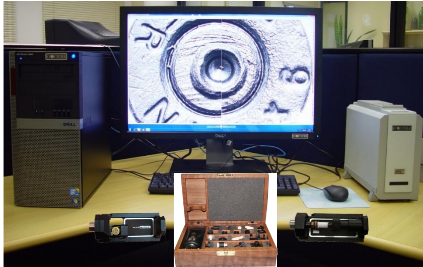
Figura 23 – Estação de Aquisição de Dados (DAS) Evofinder® composta por computador pessoal, escâner e acessórios de fixação de elementos de munição.
