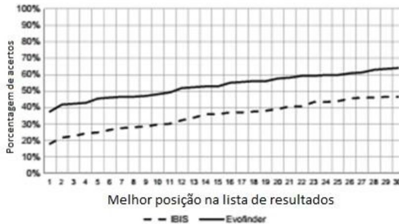
Figura 19 – Gráfico representando a porcentagem cumulativa de acertos na lista de resultados de comparações tanto de pino percussor quanto de marca de culatra (até a posição 30) conforme fornecido pelo Evofinder® e pelo IBIS® Heritage™.
