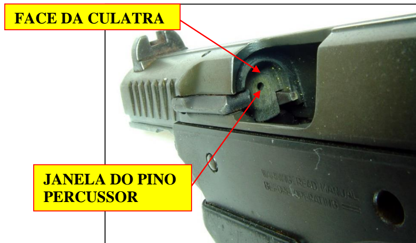
Figura 8 – Fotografia identificando a face da culatra e janela do pino percussor em uma pistola.
