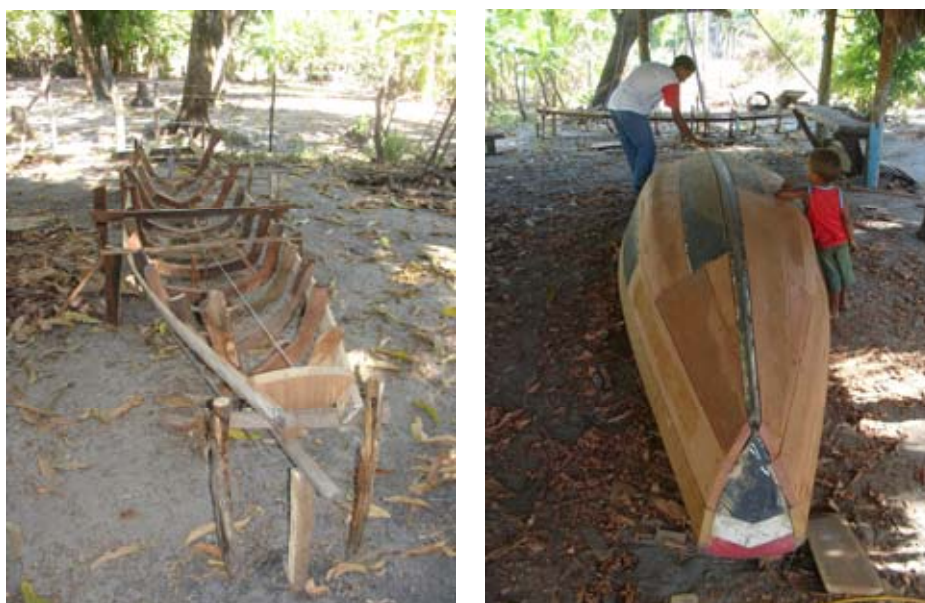
Figura 3.17 – Estrutura de canoa em estaleiro da comunidade de Tapuio.
