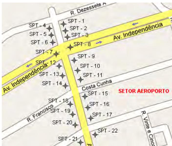
Figura 4.14 - Localização dos furos de sondagem na obra, no setor aeroporto em Goiânia
