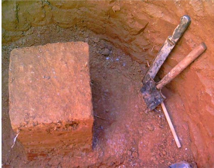
Figura 5.2 - Poços de coleta de amostra indeformada
