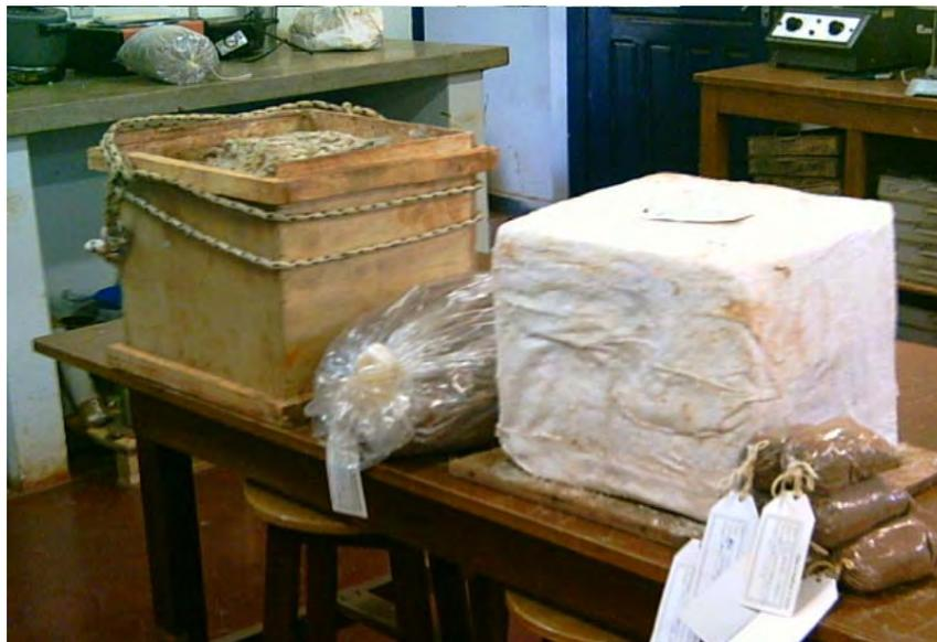
Figura 5.3 - Amostras deformadas e indeformadas no laboratório após coleta
