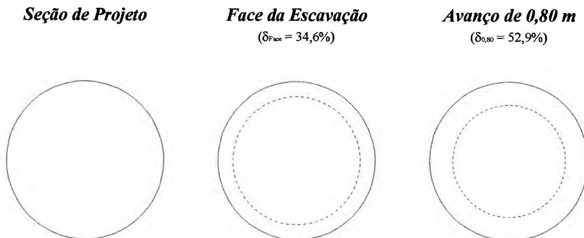
Figura 6.1 – Nível de convergência da seção do trecho “A” do setor de emboque.
