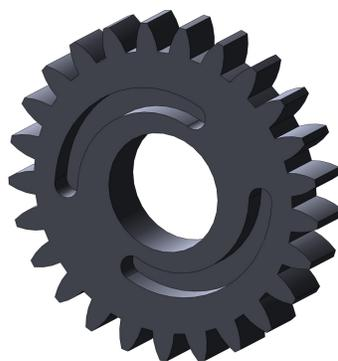
Figura 3.4: Engrenagem guia com dois rasgos em espiral.
