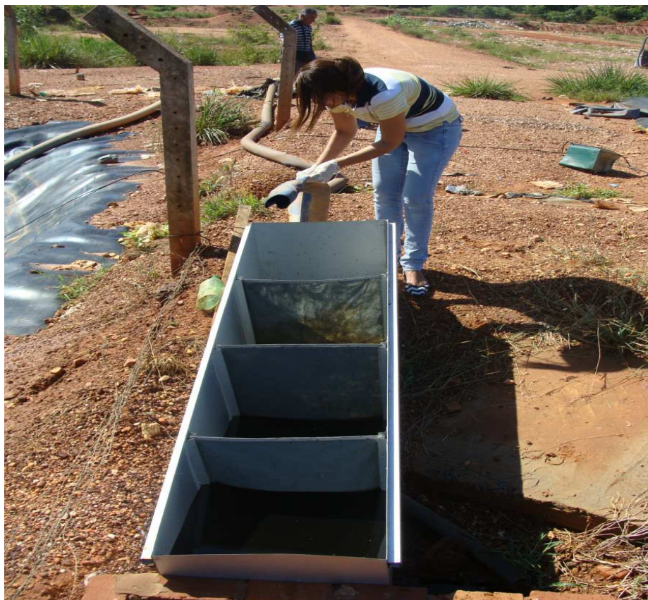
Figura 3.2 – Canal experimental no aterro sanitário de Cuiabá-MT.
