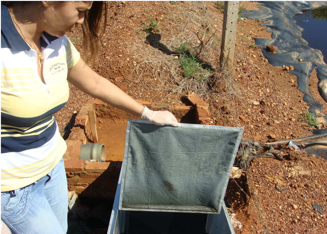
Figura 3.7 – Painel de geotêxtil no canal experimental para 1 dia de filtração. Fonte: Arquivo pessoal (Silva, S.A, 2013)
