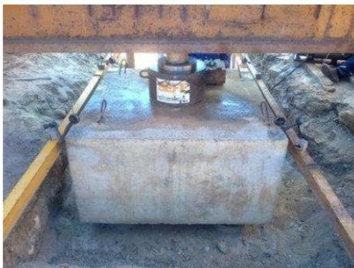
Figura 2.75 – Detalhe do contato do bloco com a viga de reação (Soares, 2011)
