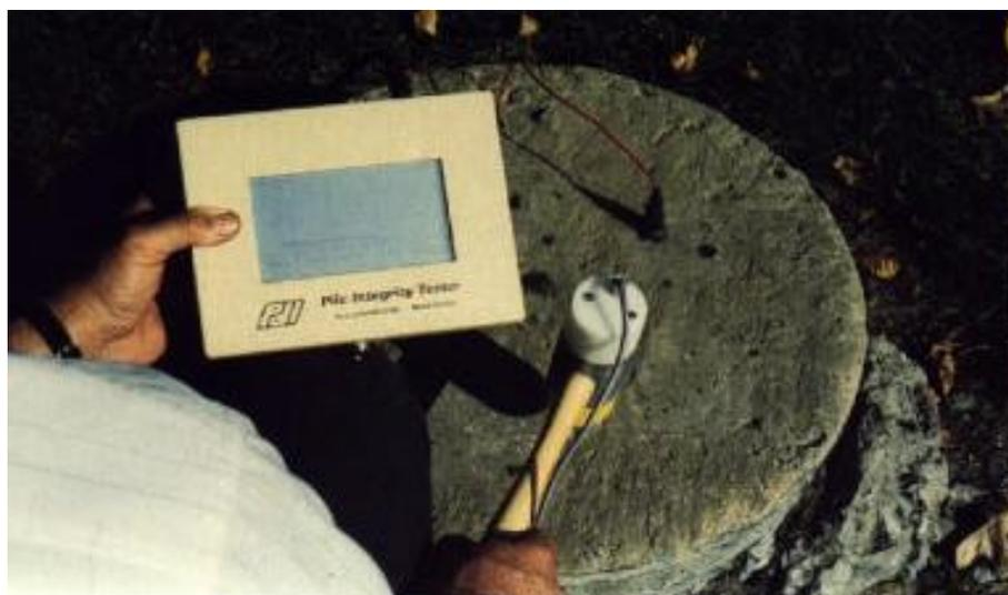
Figura 2.86 – Ensaio de integridade da estaca P.I.T..
