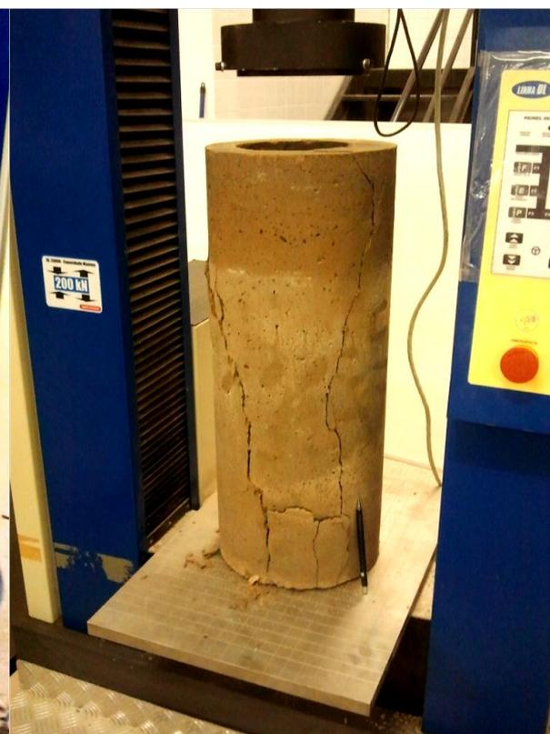
Figura 3.29 – Corpo de prova após a ruptura do defeito.
