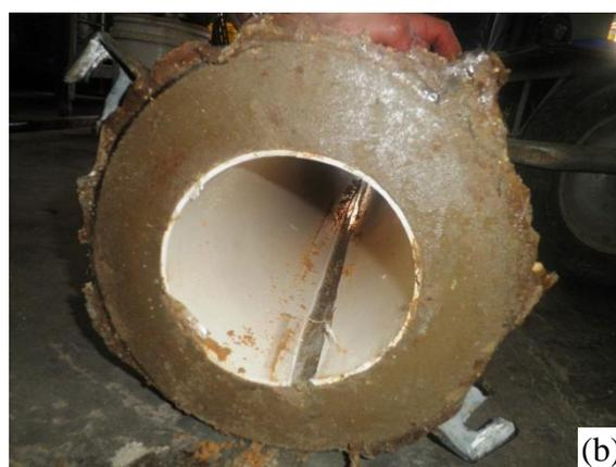
Figura 3.24 – Dimensões do cilindro bipartido utilizado para moldar os a seção transversal defeituosa das estacas.
