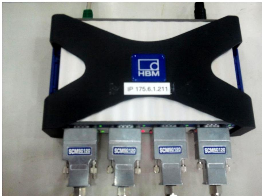
Figura 3.64 – Sistema de aquisição de dados utilizado na pesquisa (*QuantumX MX840A – HBM*).
