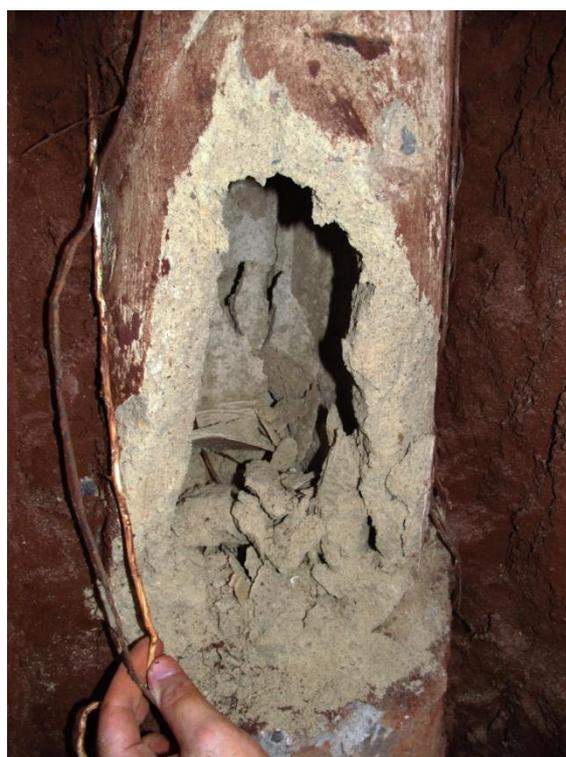
Figura 4.28 – Detalhe do defeito após a realização das provas de carga no radier  $CD_{1(EXP)}$ .
