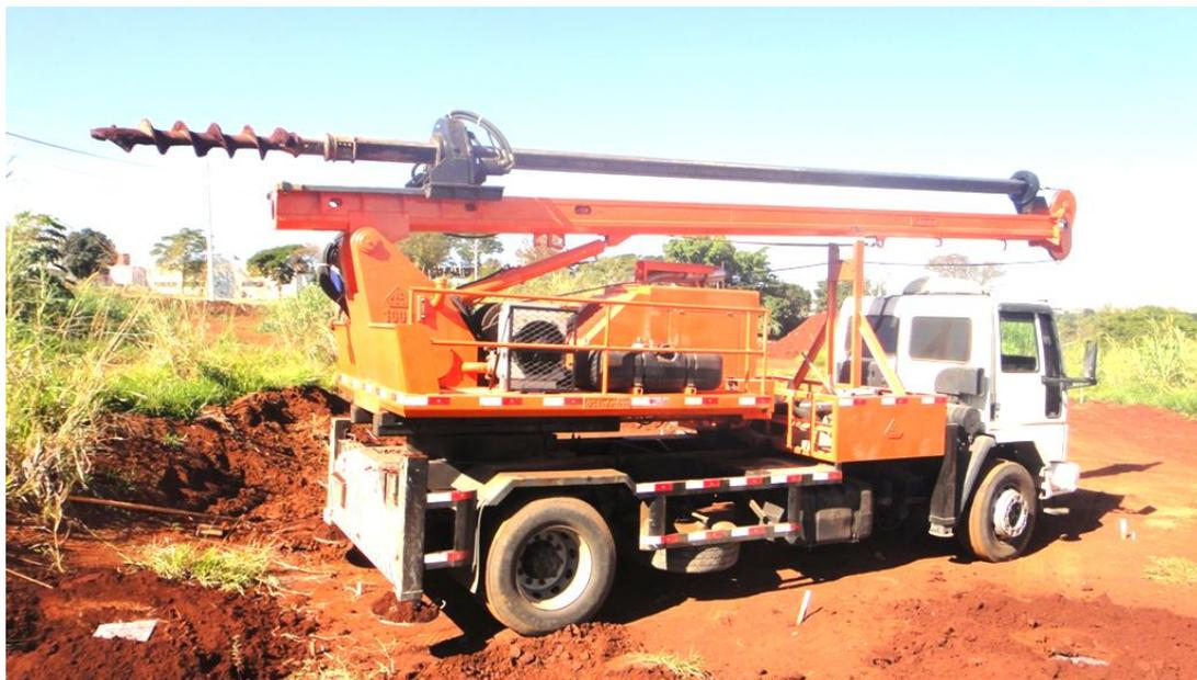
Figura 3.37 – Perfuratriz utilizada para escavação das estacas.
