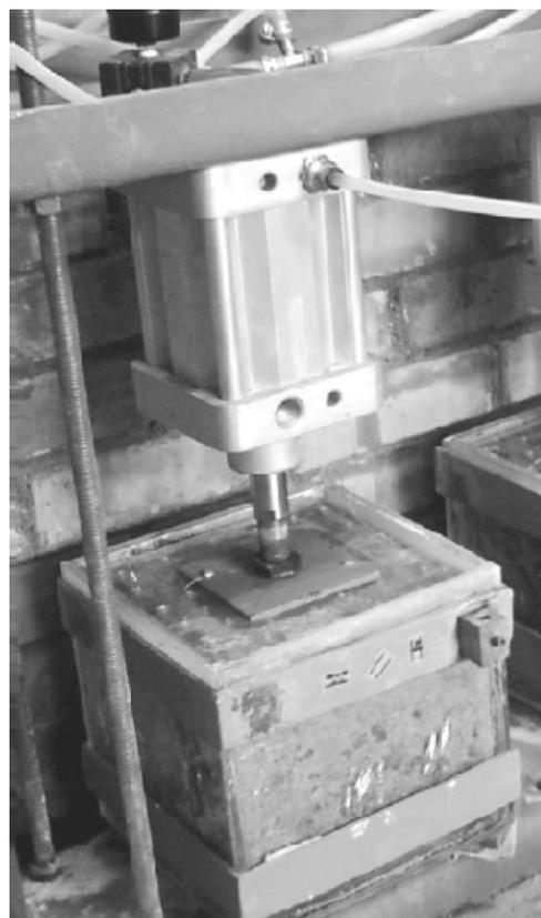
Figura 2.81 – Sistema de aplicação de carga em modelo em escala reduzida (Yilmaz, 2010).
