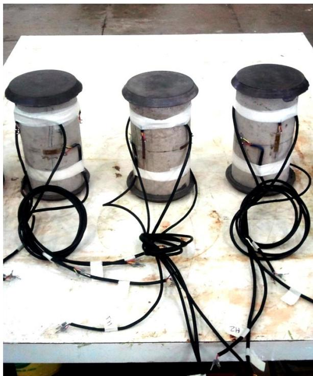
Figura 3.62 – Corpos de prova com a sua respectiva instrumentação.
