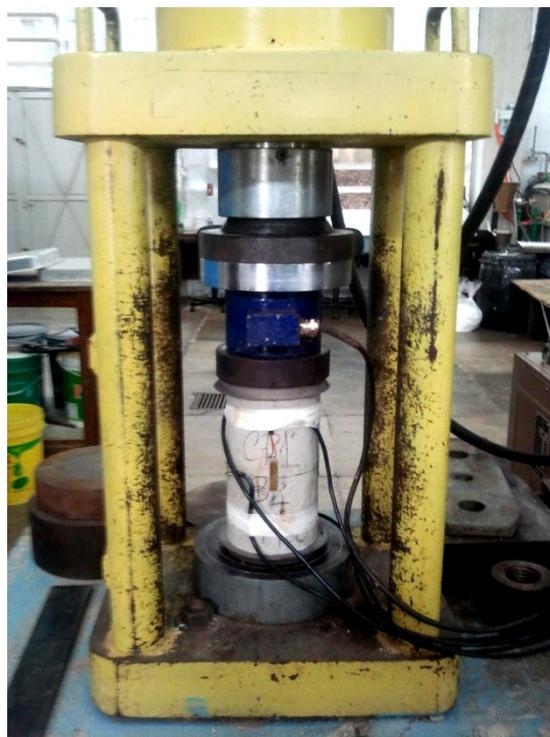
Figura 3.63 – Corpo submetido ao ensaio de resistência a compressão com aquisição direta das cargas aplicadas e deformações registradas.
