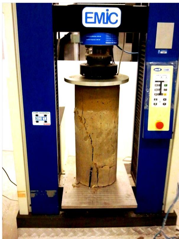
Figura 3.28 – Instante da ruptura do defeito no laboratório.
