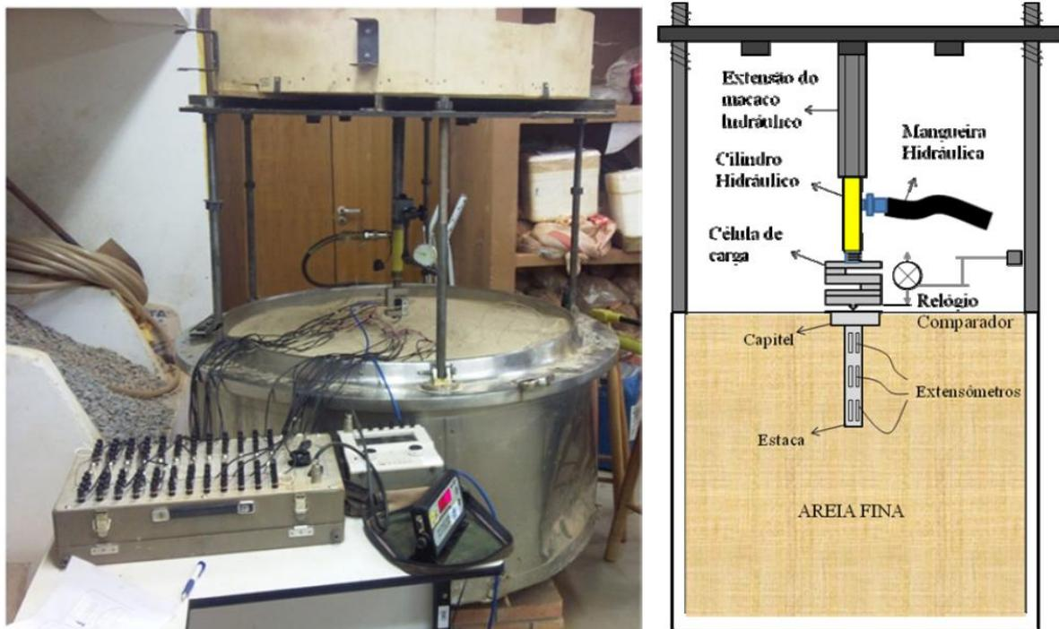
Figura 2.84 – Esquema de disposição dos equipamentos e desenho esquemático dos dispositivos utilizados nas provas de carga (Tavares, 2012).
