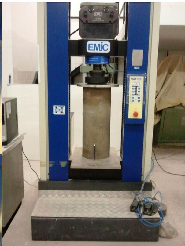
Figura 3.27 – Início do carregamento no corpo de prova que simula o defeito.
