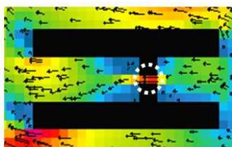
**Figura 4.13.** Efeito de canalização entre os blocos “H”
