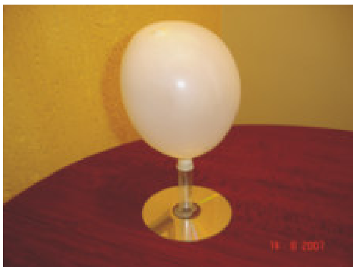
Figura 15 – O CD Flutuante desliza sobre uma mesa lisa pela reação do ar sobre o brinquedo.
