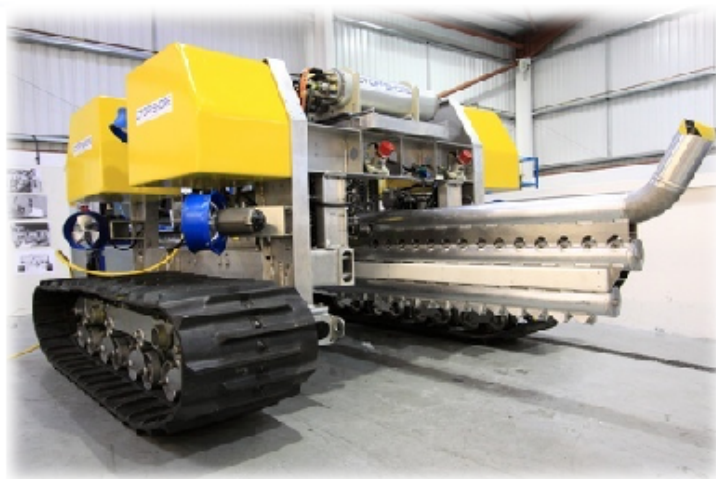
Figura 1.6: O ROV Classe Especial MV Nico de escavação submarina para instalação de turbinas eólicas ( offshore ).
