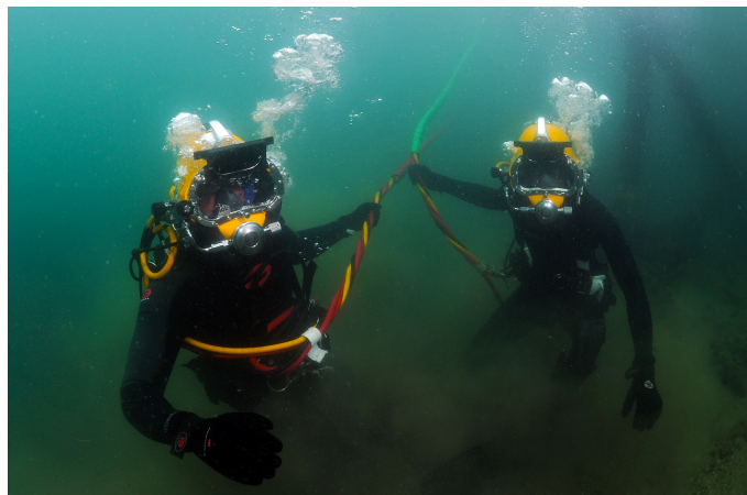
Figura 1.2: Mergulhadores com umbilical de suporte de vida. [Fonte: Jayme Pastoric 2 .]
