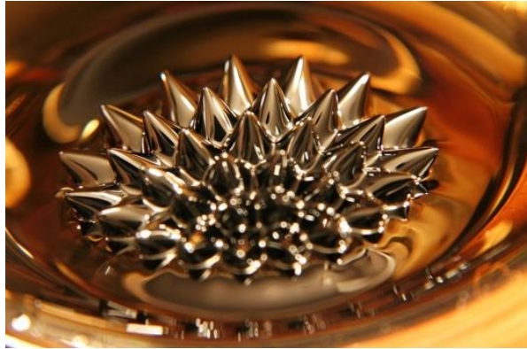
Figura 03: Imagem de ferrofluido em um vidro de relógio sob a ação de um super-ímã [Fonte: < www.hypescience.com/21749-curiosidade-ferrofluido >. Acesso em 05 abr. 2014]
