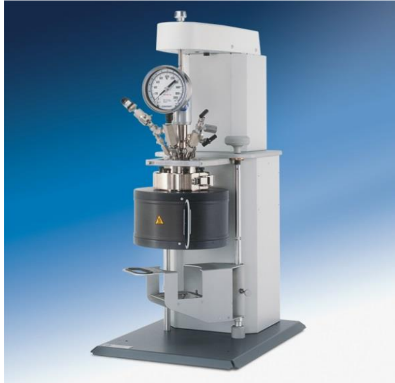
Figura 33: Reator Hidrotermal Parr usado nas Sínteses – pertencente ao Laboratório de Fluidos Complexos do Instituto de Física da Universidade de Brasília (UNB).
