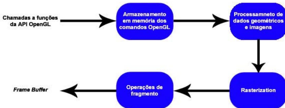
Figura 2.3 – Funcionamento do pipeline *OpenGL*.
