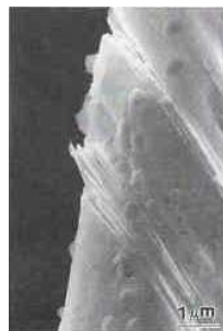
Figura 3.5- Intrusões e Extrusões em uma superfície de cobre.
