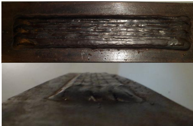
Figura 4.84. Camada de 10 cordões com superposição 50% e parâmetros do cordão 20.
