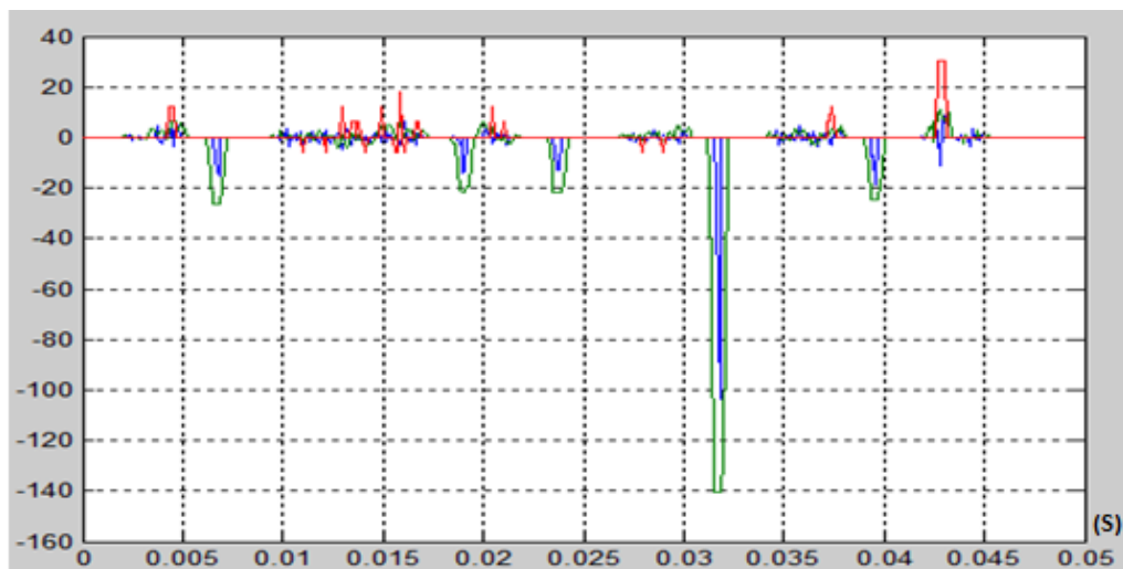
Figura 4.43. Sinal no domínio do tempo após o tratamento com Transformada Rápida de Fourier e com os diferentes filtros. Em azul, o sinal original com os primeiros filtros, e em verde e vermelho, os demais filtros.
