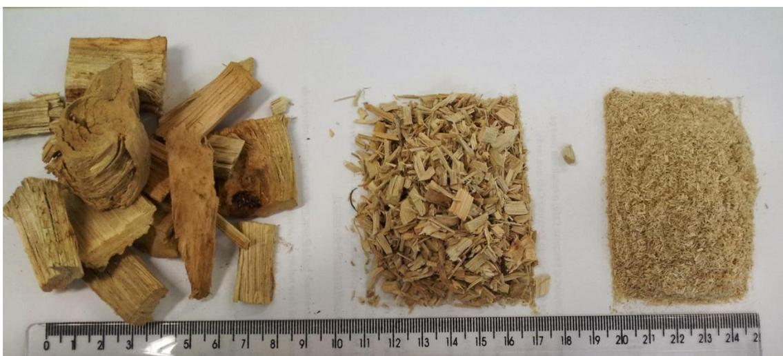
Figura 15 – Da esquerda para direita: amostra em forma de cavaco; amostras trituradas, menores que 10 mm; amostras moídas, menores que 2 mm.
