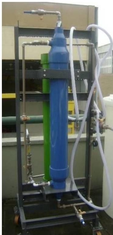
**Figura 4.13.** Sistema de microfiltração de água com carvão ativado pressurizado.
