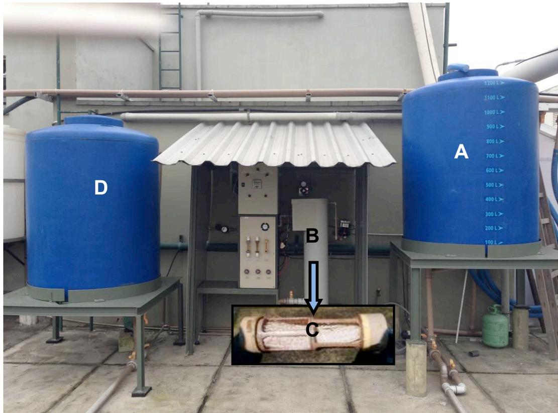
**Figura 4.14.** Sistema de concentração de biomassa por microfiltração composto de um tanque de armazenamento de cultura (A), sistema de filtragem (B), contendo uma membrana (C), e um tanque de armazenamento de água residual (D).
