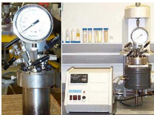
**Figura 4.16.** Reator Parr utilizado na hidroesterificação de *Scenedesmus* sp.
