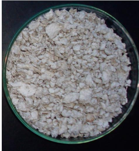
**Figura 4.6.** Biomassa lignocelulósica residual proveniente do sistema de decantação da indústria de celulose.
