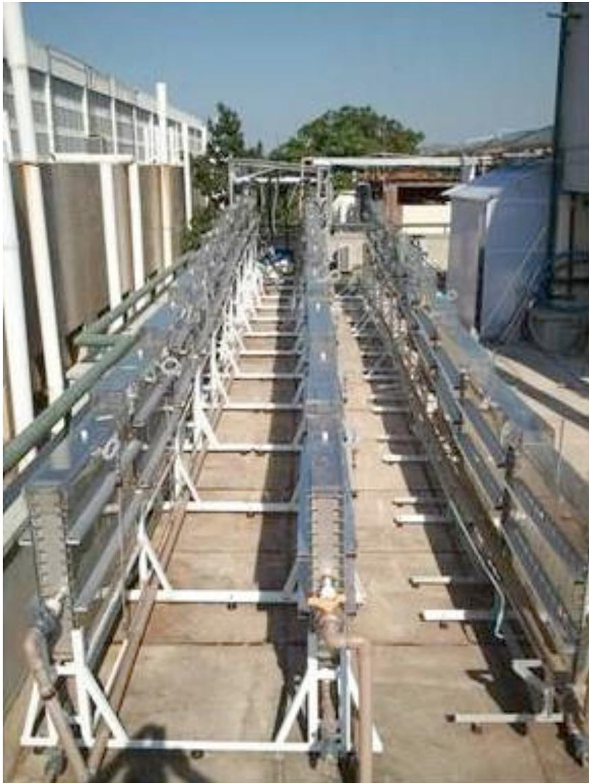
**Figura 4.10.** Fotobiorreatores verticais do tipo janela da unidade piloto do NBPD/EQ/UFRJ.
