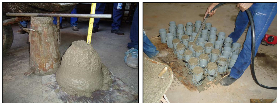
Figura 3.23 – Abatimento (slump) e moldagem dos corpos de prova
