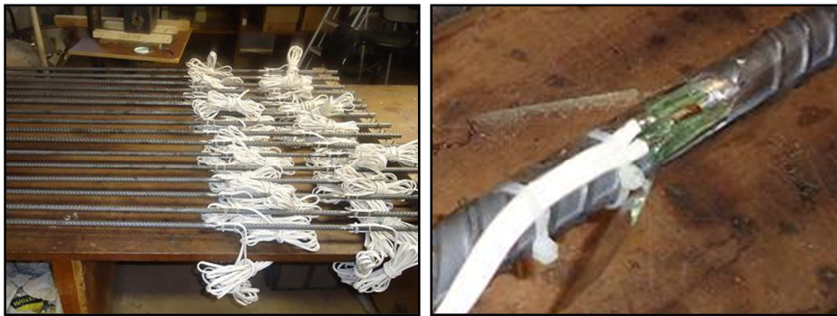
Figura 3.27 – Instrumentação das barras de flexão
