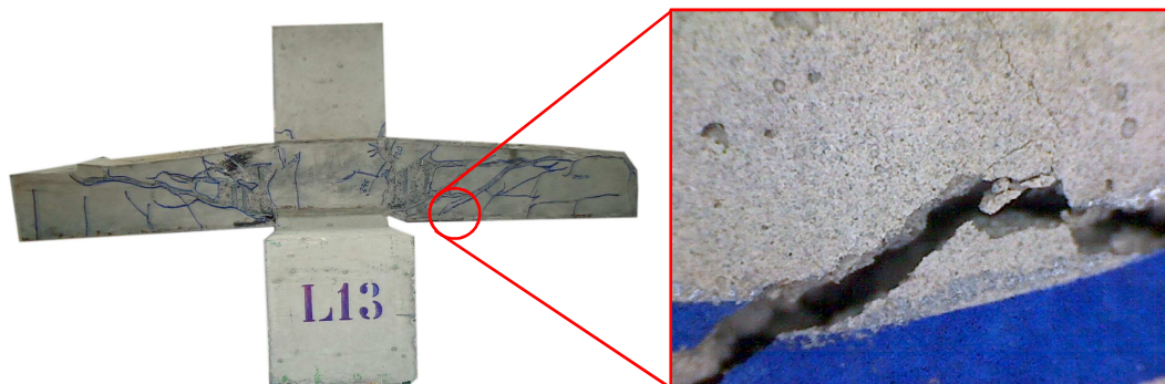
Figura 4.2 – Verificação das fissuras na região frontal da laje
