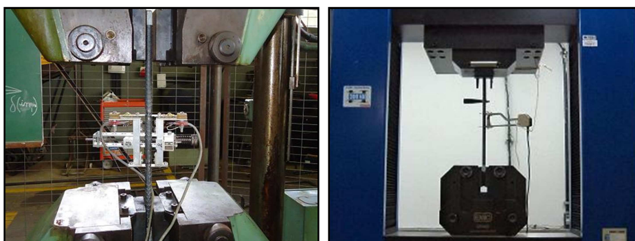
Figura 3.43 – Ensaios realizados nos corpos de prova de aço
