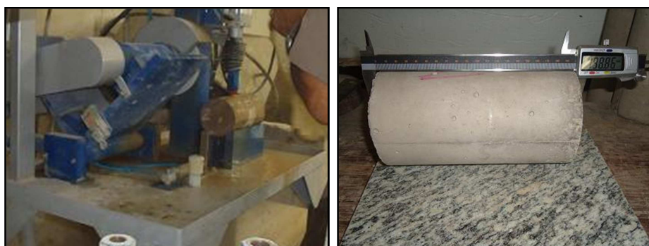
Figura 3.42 – Preparação dos corpos de prova para os ensaios
