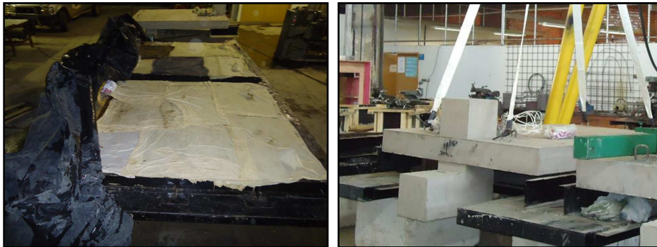
Figura 3.26 – Cura e desforma das lajes
