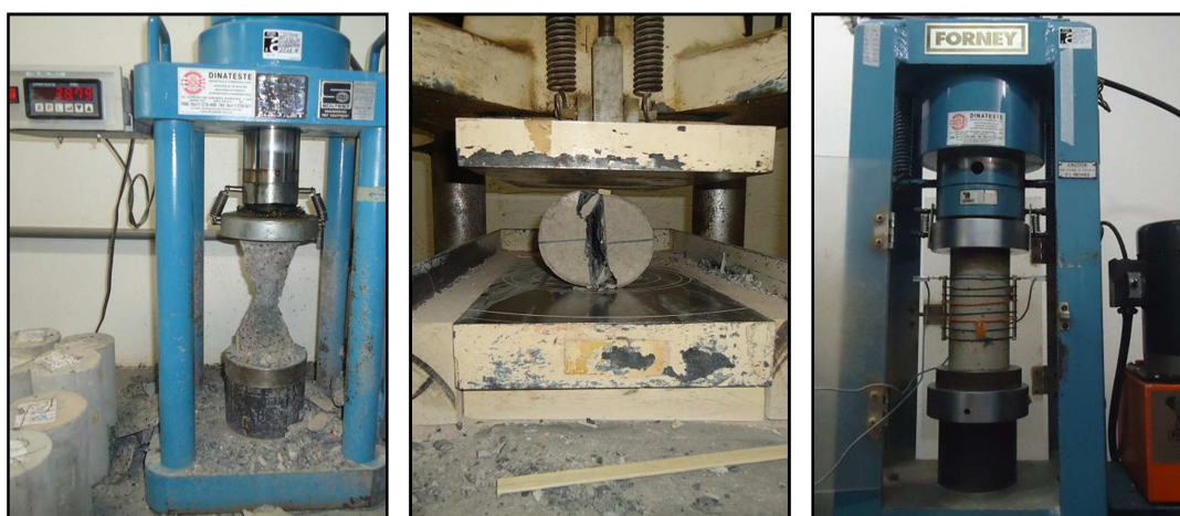
Figura 3.41 – Ensaio realizado nos corpos de prova de concreto
