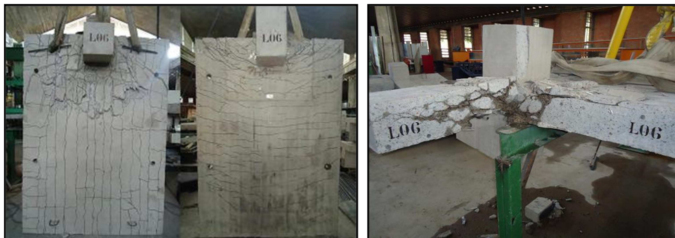
Figura 4.16 – Visão geral de fissuração nas faces superior, inferior e no corte da laje L06
