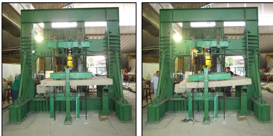
Figura 4.3 – Aparência do modelo L7 nos estágios inicial e final de carregamento
