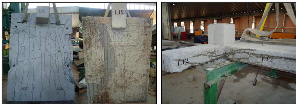
Figura 4.28 – Visão geral de fissuração nas faces superior, inferior e no corte da laje L12
