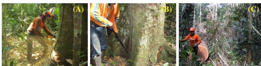
Figura 3.34. Posturas mais frequentes observadas durante as operações: (A) operador de motosserra durante a derrubada; (B) auxiliar de corte durante limpeza de fuste na região de corte, e; (C) auxiliar de arraste durante em desobstrução no local de acoplamento da tora.
