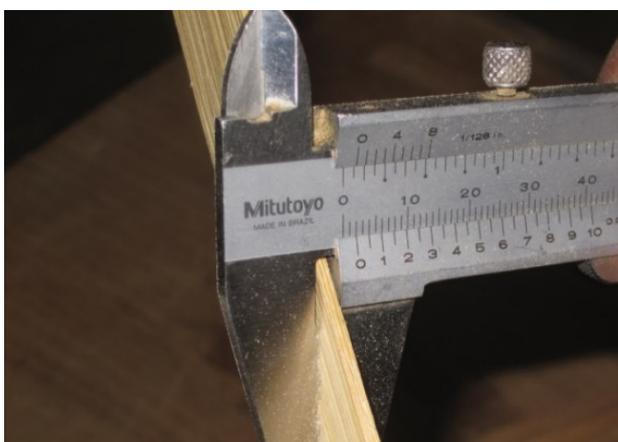
Figura 48: Espessura final da lamina de bambu.
