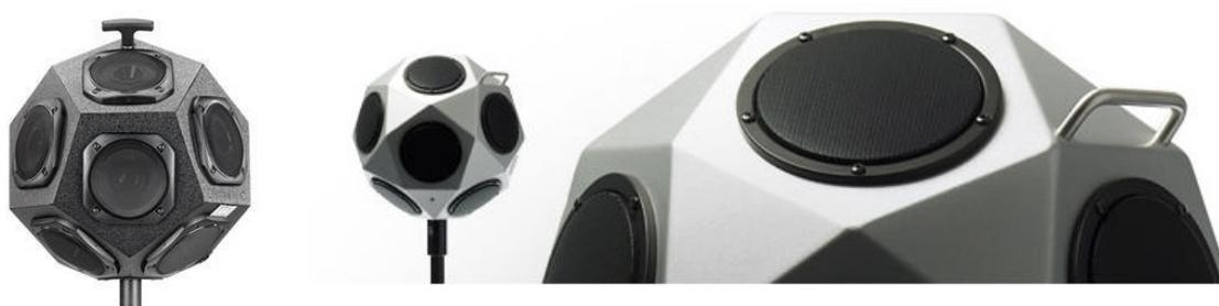
Figura 05: Fonte Sonora Omnidirecional para ensaios em laboratório.
