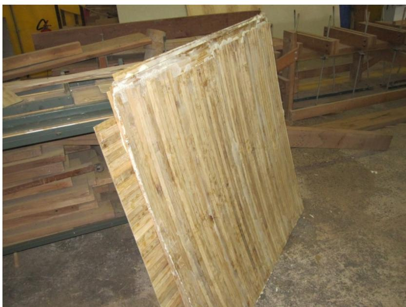
Figura 55: Painéis de bambu laminado colado sem acabamento.
