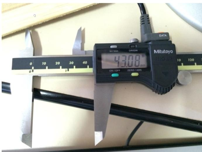
Figura 64: Parquímetro digital utilizado no ensaio.
