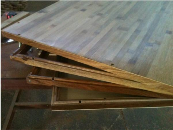
Figura 61: Protótipo com a demonstração dos anéis removíveis e a membrana em BaLC.
