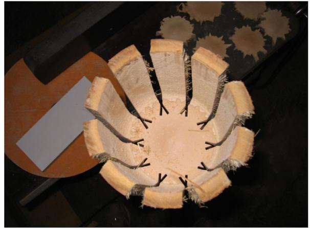
Figura 43: Bambu cortado pela máquina fatiadora.
