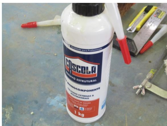
Figura 54: Adesivo utilizado para a colagem das ripas de bambu.
