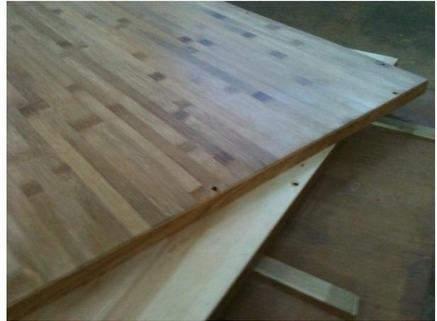
Figura 62: Membrana de BaLC do topo e placa de compensado de madeira do fundo.
