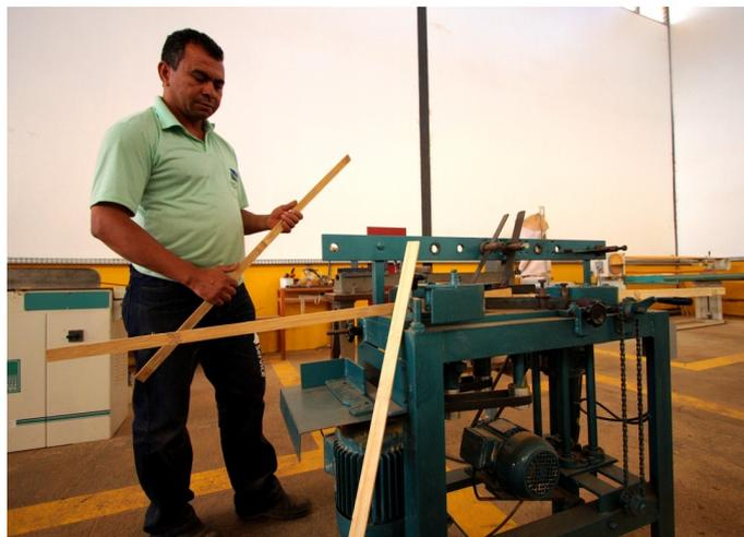
Figura 44: Máquina taquari para nivelamento de ripas de bambu.
