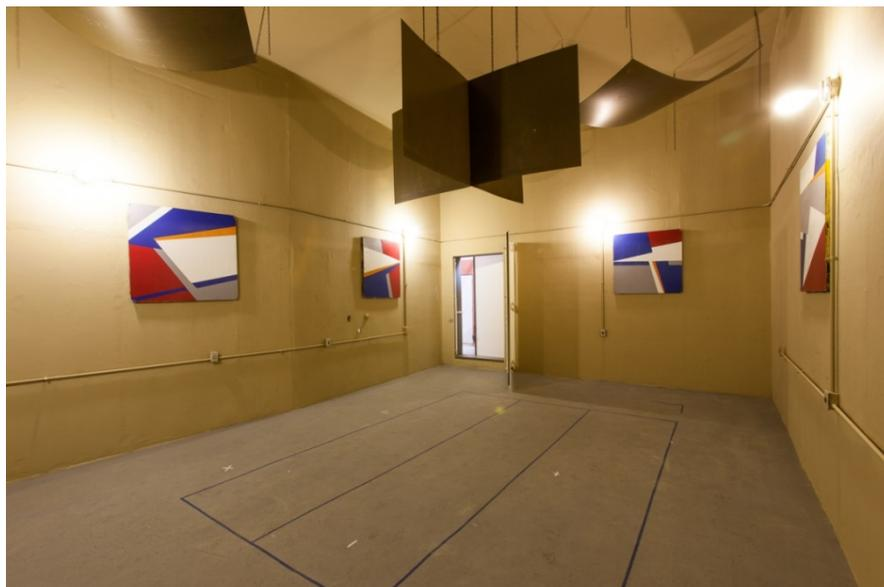
Figura 68: Câmara reverberante da EAC/UFSM.
