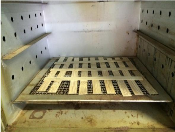
Figura 50: Corpos de prova em secagem na estufa.
