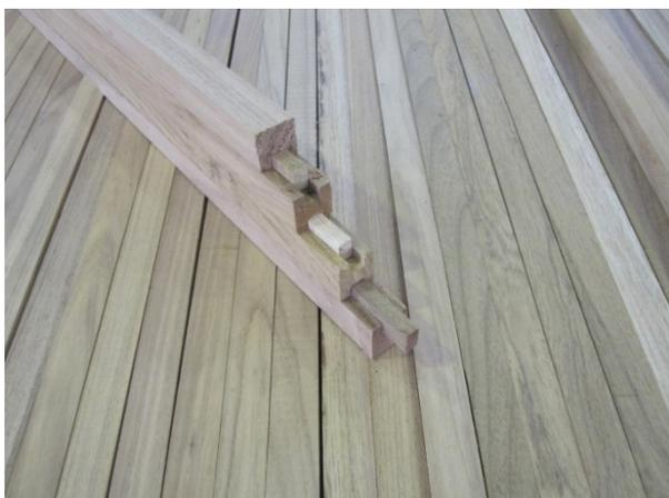
Figura 56: Sistema de encaixe tipo macho-fêmea.
