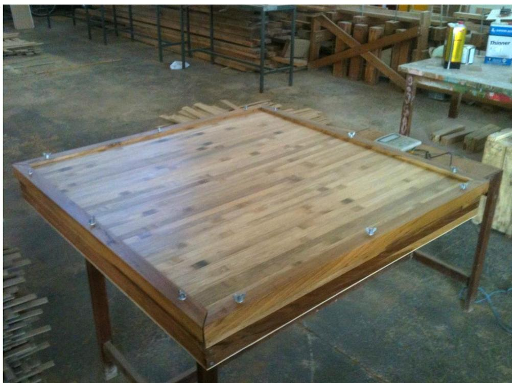
Figura 60: Protótipo do dispositivo de tipo membrana ressonante finalizado.
