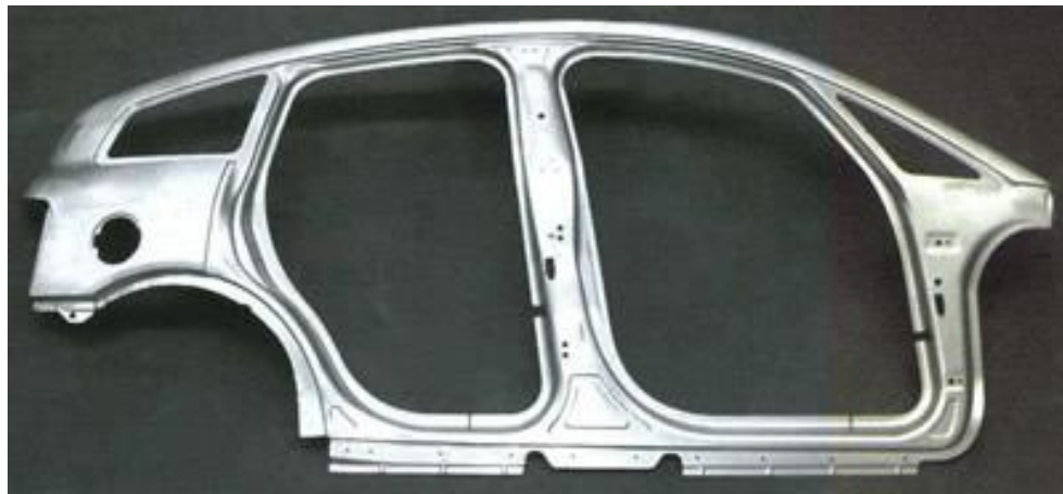
Figura 1.1 - Lateral do Audi A2 produzida com um unico painel estampado
