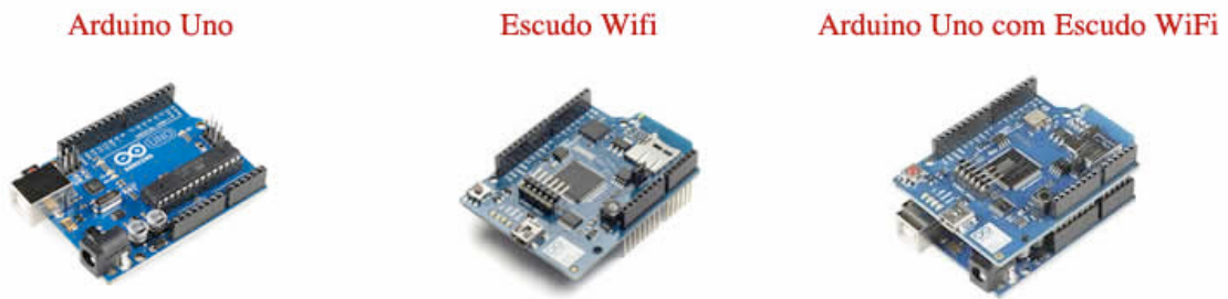
Figura 2.4 - Encaixe de escudos Arduino
