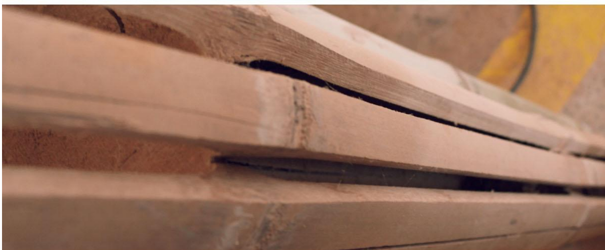
A Figura 36 - Transformação de seção de colmo em ripas A: Seção e colmo secando em prateleiras. Fonte: autor B B: Serra de mesa com discos duplos paralelos. Fonte: autor C C: Seção de colmo cortada em ripas. Fonte: autor
