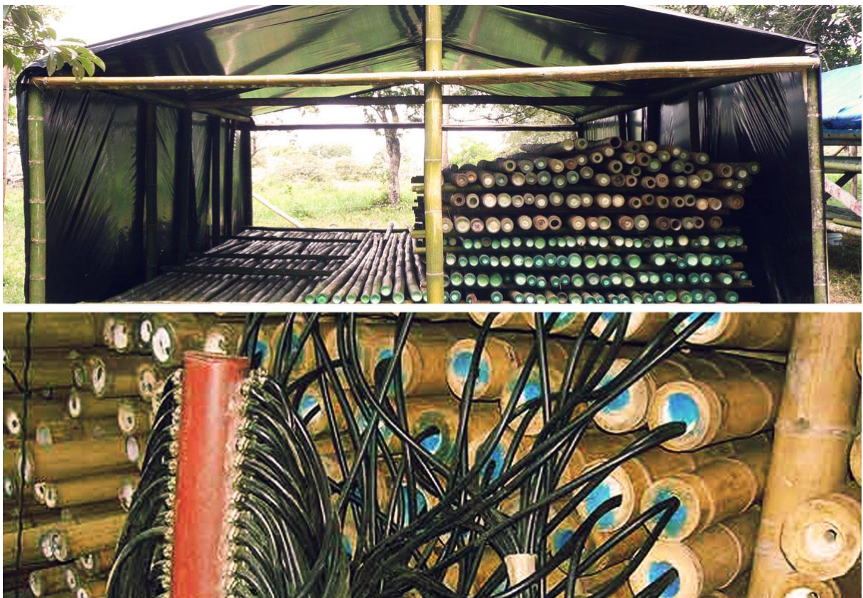
Figura 25 - Processos de secagem do bambu A: Secagem dos colmos em galpão aberto. Fonte: Yates (2011) B: Secagem artificial do bambu por insuflação de ar aquecido. Fonte: Stamm (2013)
