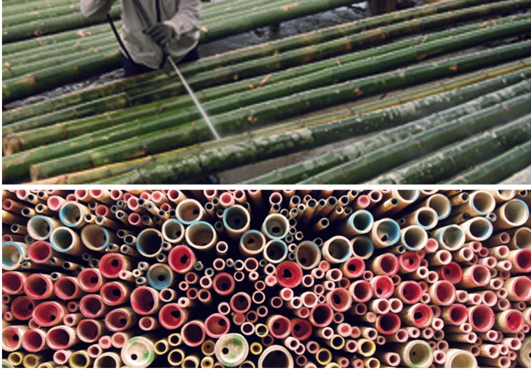
Figura 22 - Preparação dos colmos para usinagem A: Lavagem do colmo do bambu. Fonte: Emery (2013) B: Seções de colmo classificadas com a utilização de cores. Emery (2013)
