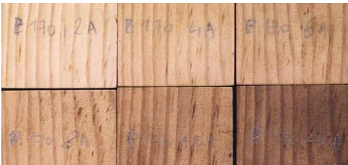
Figura 33 - Madeira termicamente modificada a 170°C por 2 a 16 horas Fonte: Esteves e Pereira (2008)
