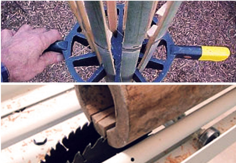
Figura 23 - Ferramentas para confecção de ripas de bambu a partir de colmos A: Faca de corte para fendilhamento do colmo em ripas. Fonte: Jeff (2012) B: Serra de mesa com discos duplos paralelos. Fonte: Guzman (2010)
