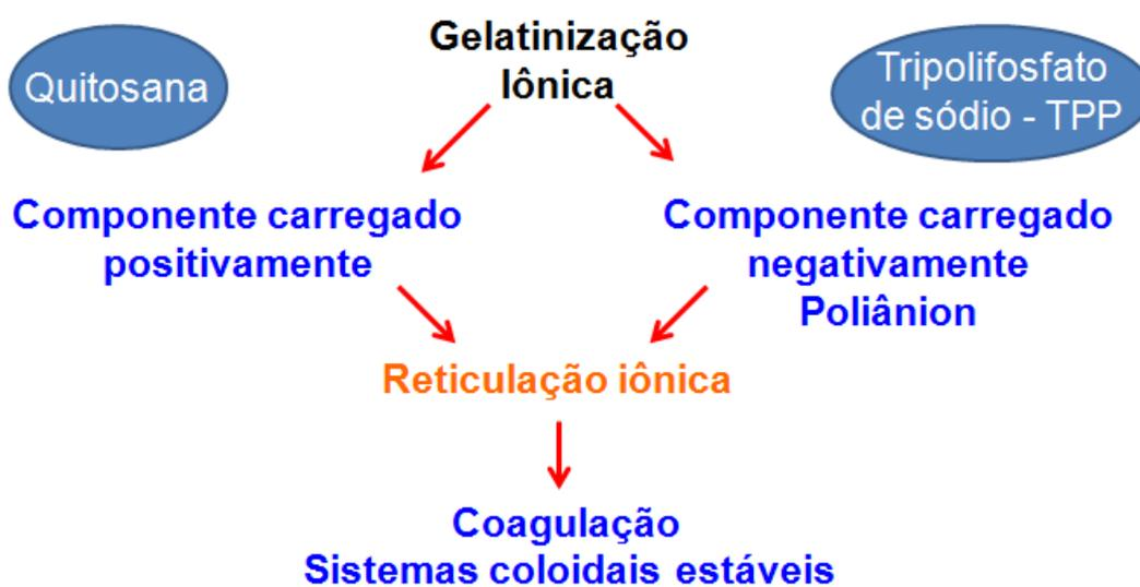
**Figura 1** Esquema da técnica de gelatinização iônica
