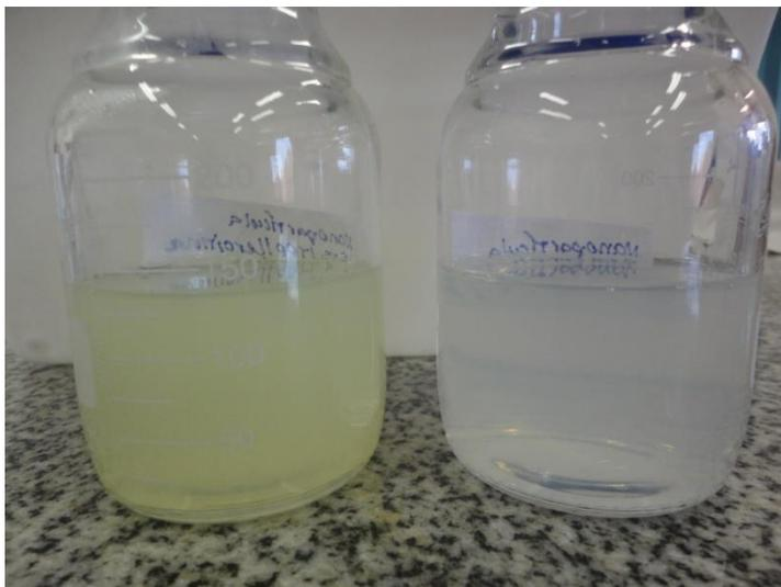
**Figura 10** - Suspensão coloidal de nanopartículas de QTS/TPP na presença (A) e na ausência de quercetina (B).
