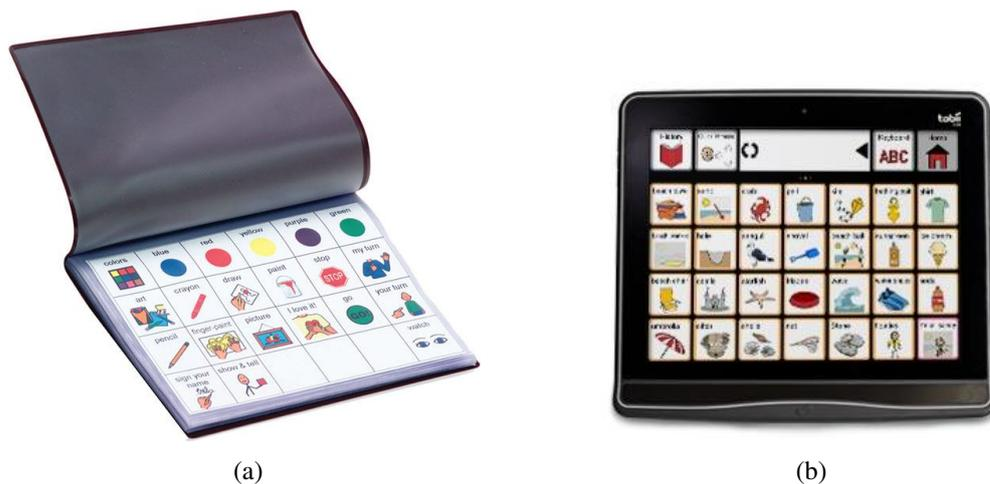
Figura 1.2: Exemplos de equipamentos de CAA: (a) prancha de comunicação pictográfica [11], (b) prancha dinâmica embarcada em computador portátil [12].
