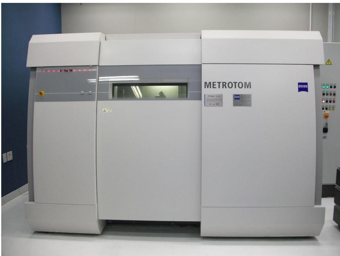
Figura 3.6. Tomógrafo Metrotom 1500 utilizado para os estudos de metrologia das impressões 3D.
