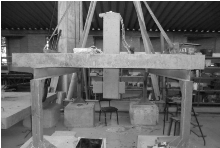
Figura 3.30 - Laje sobre a plataforma
