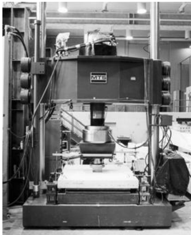
Figura 2.40 - Sistema de ensaio - Estrutura de reação (SISSAKIS, 2002)
