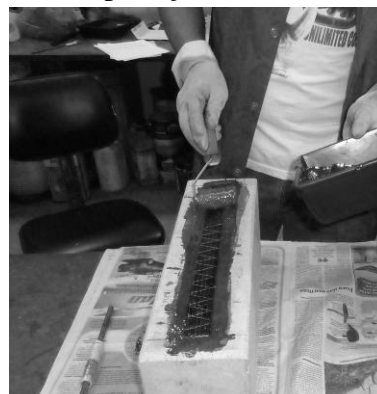
(d) Aplicação da Manta I
