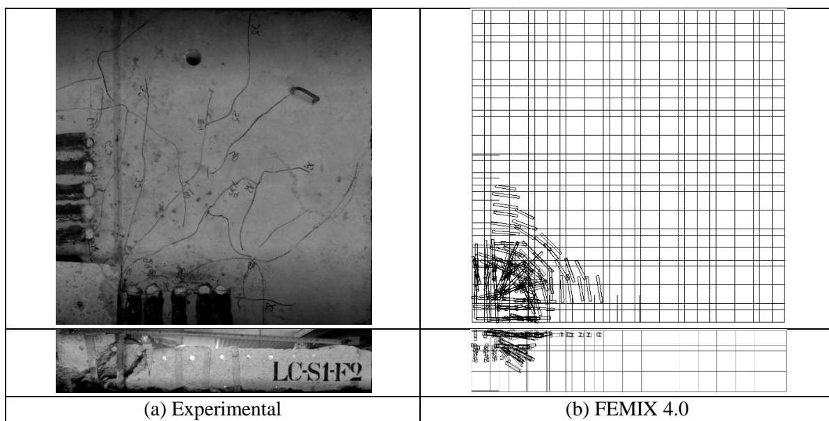
Figura 5.36 - Padrão de fissuração - LC-S1-F2 (FEMIX 4.0)
