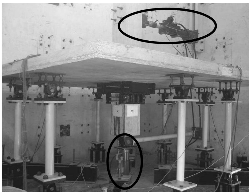
Figura 2.45 - Sistema de ensaio - Estrutura de reação (WIDIANTO, 2006)
