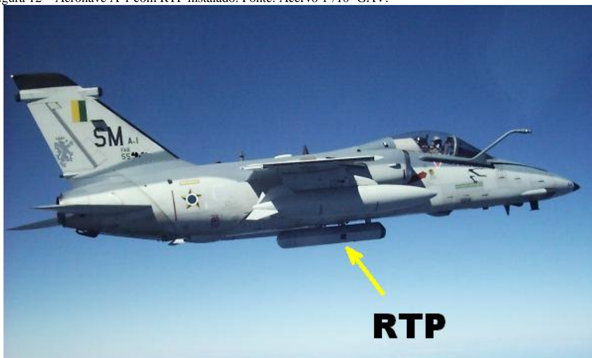
Figura 12 – Aeronave A-1 com RTP instalado. Fonte: Acervo 1º/10º GAV.
