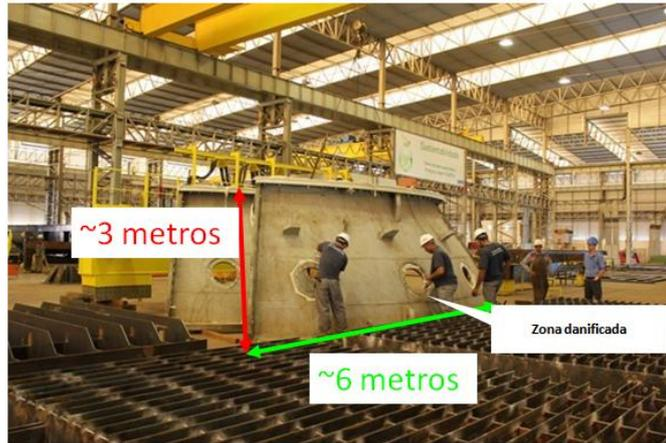
Fig. 2.19. Reparação de turbinas hidrelétricas, realizada por uma equipe de soldadores.
