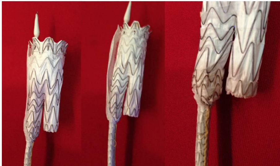
Figura 15. Imagem macroscópica da EPm sem lacerações após o teste de fadiga.
