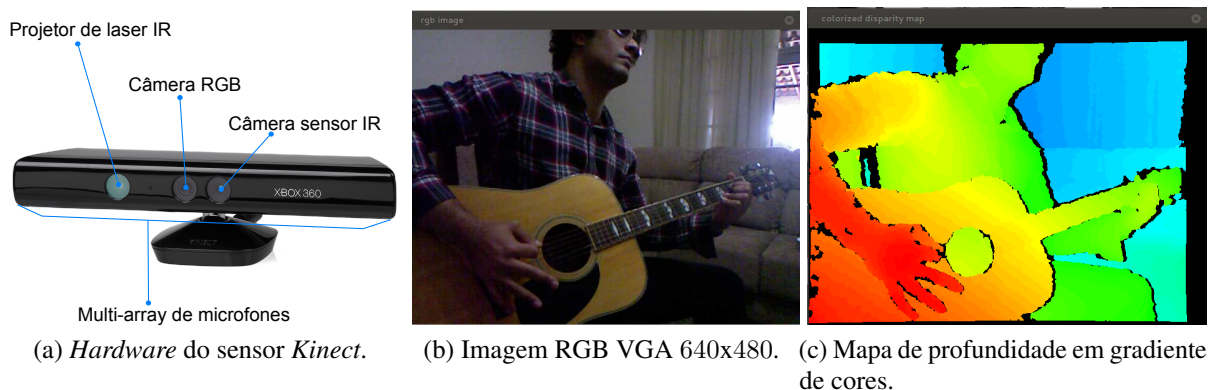
Figura 2.3: Composição e amostragem do sensor Kinect .
