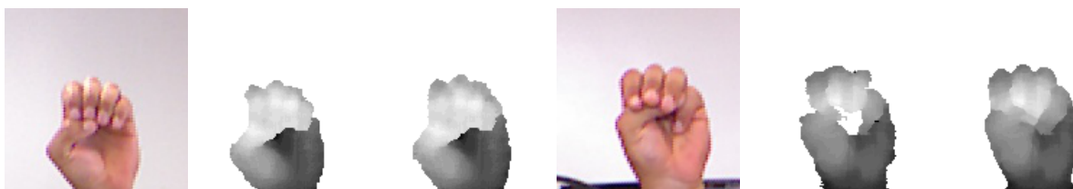
Figura 6.2: Resultados preliminares para uma proposta de regularização das imagens de profundidade obtidas com o sensor Kinect .
