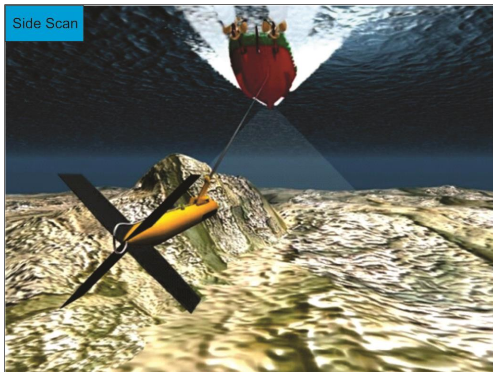
Figura 3.1: Ilustração representativa da forma de aquisição por sonografia de fundo. Notar sonar de varredura lateral acoplado ao barco sendo rebocado na medida em que o levantamento geofísico se concretiza. Imagem adaptada de: www.morb.com.br .
