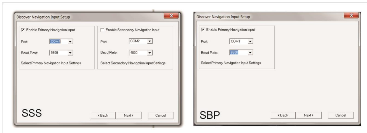
Figura 1.5: Janelas de configuração dos sensores SSS e SBP para seleção das portas seriais e baud rate .
