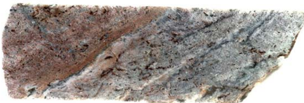
Figura II.63. Testemunho de sondagem do furo 53/32 apresentando dois tipos de carbonatito bandados, na parte a esquerda mais rico em Fe e a direita mais dolomítico. Localização das amostras: Figura anexo 01
