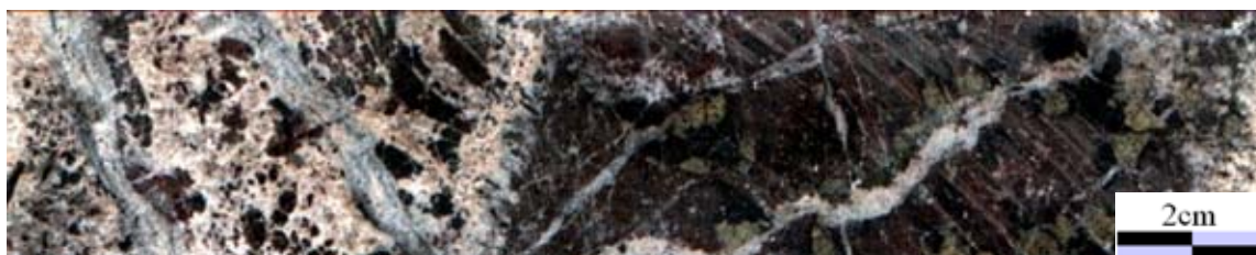
Figura II.42 Amostra 16 furo 9596/3738 130m. Dique de foscorito cortando rocha ultramáfica flogopitizada rica em anatásio. Localização: Figura anexo 01.
