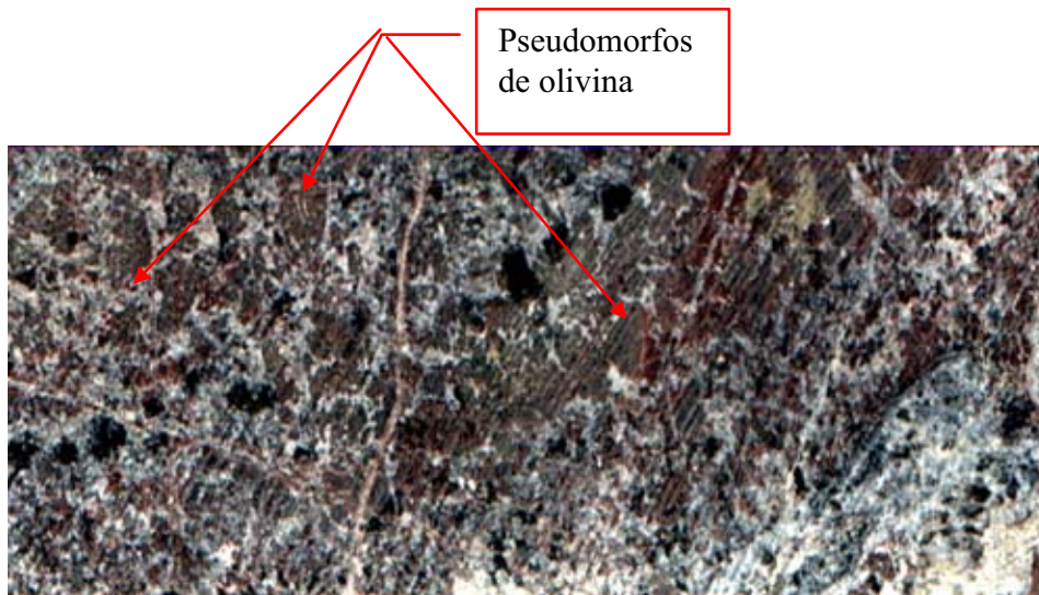
Figura II.40. Amostra 95k. Testemunho de sondagem furo 95/96/37/38 da região da Lagoa Seca para ilustrar variedades de rocha da série foscoritica. Apesar de intensamente flogopitizada nota-se ainda pseudomorfos de olivina que comprovam sua filiação com a série foscoritica. As massas na cor marrom arredondadas são pseudomorfos de olivina cumulus e as manchas brancas são as apatita intercumulus. A quantidade de magnetita é restrita a 5%. Localização: Figura anexo 01.
