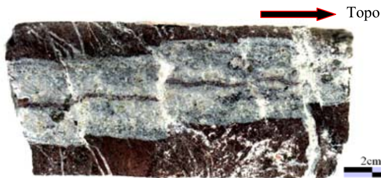
Figura II.71. Testemunho de sondagem do furo 63/34 localizado na parte central do complexo (Localização das amostras: Figura anexo 01). Dique de carbonatito com evolução de foscrito para carbonatito ou vice-versa. O liquido originalmente carbonatítico sofreu diferenciação por fluxo com fracionamento de apatita e flogopita/olivina nas bordas e na sua parte central.
