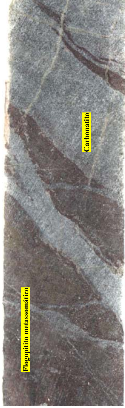
Figura II.13. Amostra furo 63/64. Flogopitito castanho de origem metassomática cortado por veios de carbonatito dolomítico. Localização: Figura anexo 01.
