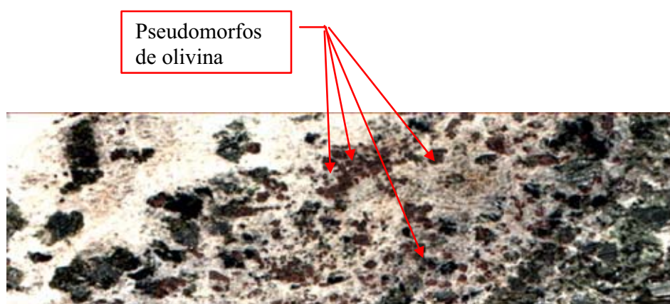
Figura II.41. Amostra am38. Testemunho de sondagem furo 69/40 localizado na frente 01. A massa branca é composta por apatita e carbonato e os minerais de cor marrom avermelhado são pseudoformos de olivina flogopitizados. Localização: Figura anexo 01.
