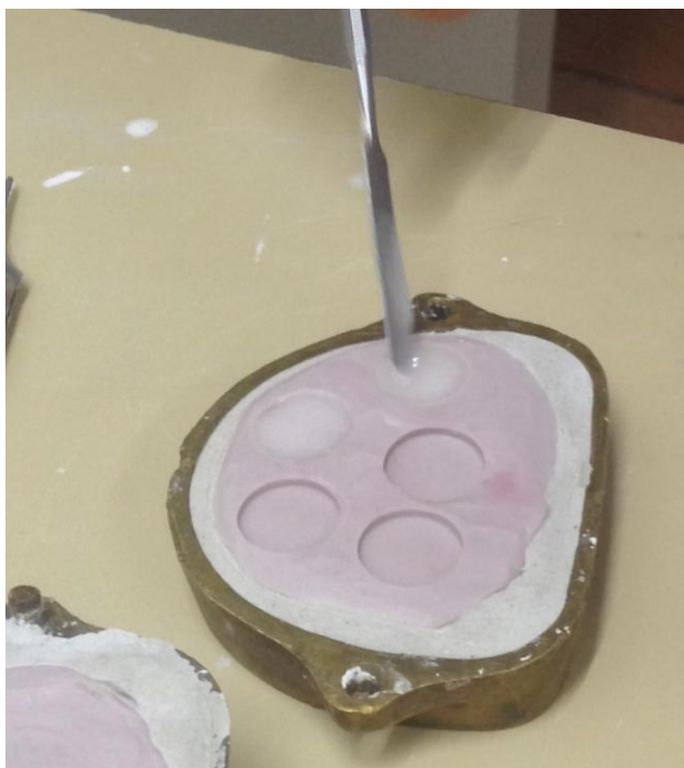
Figura 2 - Inclusão do material no molde na fase pegajosa da resina
