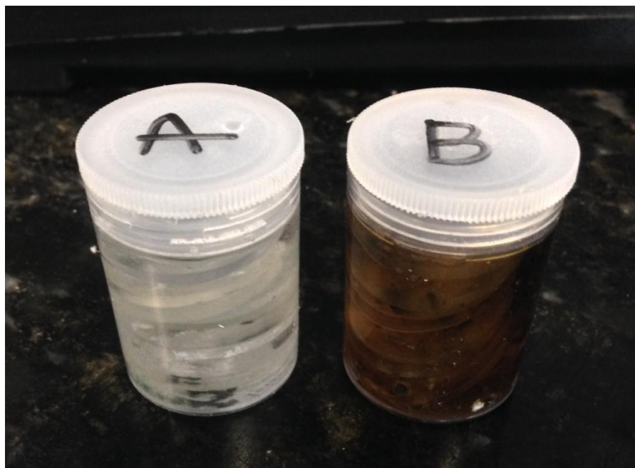
Figura 4 – Acondicionamento das amostras do grupo 1 em água destilada (recipiente de plástico A), e do grupo 2, em refrigerante à base de cola (recipiente de plástico B)
