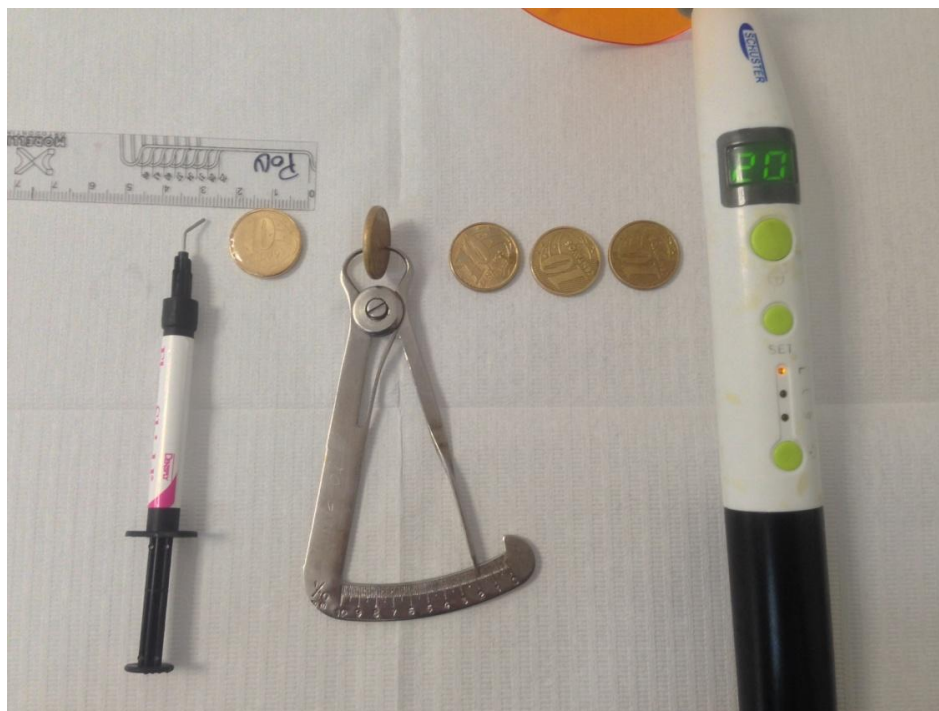
Figura 1 – Moedas de R$ 0,10 e materiais que serviram de molde para confecção das amostras
