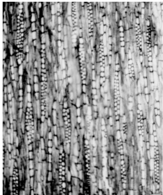
Figura 17. Siphoneugena densiflora - corte tangencial evidenciando raios abundantes 1 - 2 seriados. Escala 200 \mu\text{m} .
