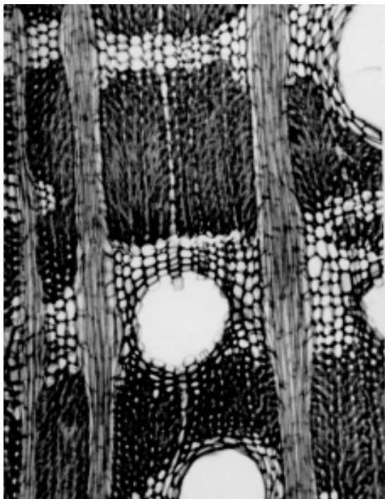
Figura 20. Vochysia pyramidalis - corte transversal mostrando um canal secretor no parênquima axial, um vaso solitário e fibras moderadamente abundantes. Escala 200 \mu\text{m} .
