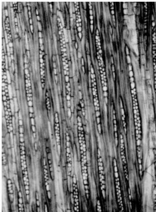
Figura 5. Micropholis grandifolia - corte tangencial indicando raios 2 - seriados. Escala 200 \mu\text{m} .
