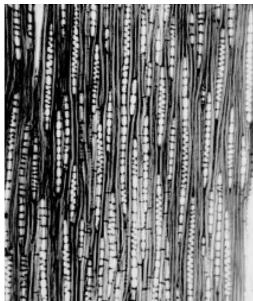
Figura 3. Maprounea guianensis - corte tangencial mostrando predominância de raios 1 - seriados. Escala 200µm
