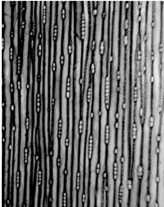
Figura 13. Podocarpus brasiliensis - corte tangencial mostrando raios 1 seriados e extremamente baixos. Escala 200 \mu m.
