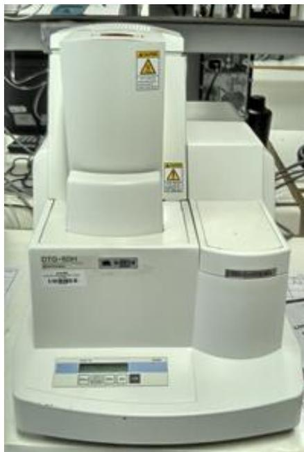
**Figura 23:** Analisador termogravimétrico Shimadzu modelo DTG-60H
