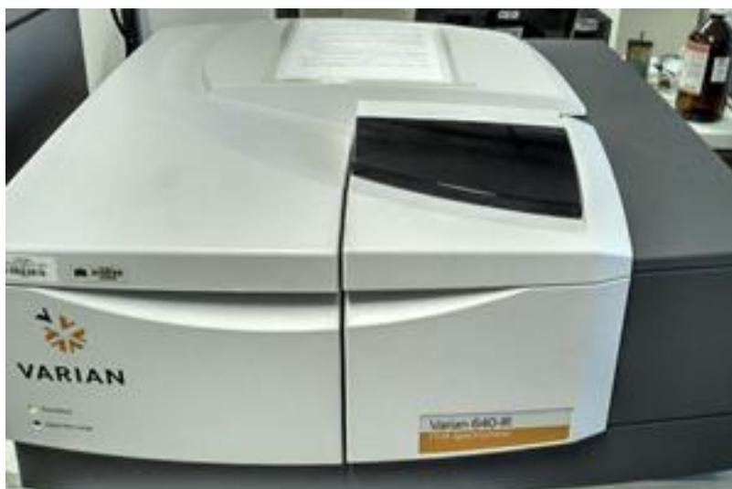
Figura 22: Espectrômetro VARIAN 640
