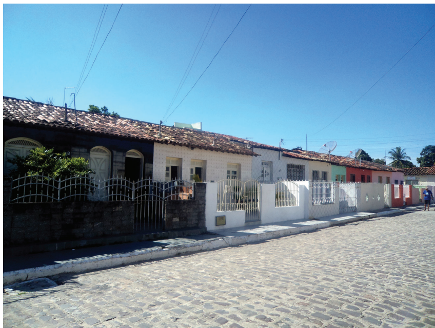
Algumas casas sofreram alterações no seu aspecto original, como grades nos muros baixos, mudança no desenho das janelas e aplicação de revestimento cerâmico na fachada. Foto: Suzete Bomfim, 2013.
