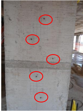
Ensaio de penetração de pino em pilares e medição do comprimento exposto
