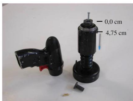
Figura 2.14- Posição do pino dentro do cano da pistola (JOFFILY, 2010).
