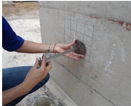
Ensaio de penetração de pino em pilares e medição do comprimento exposto
