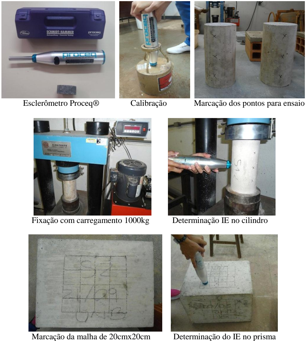
Figura 3.4- Rotina para ensaio de esclerometria em cilindros e prismas, realizada no LEM/UnB.
