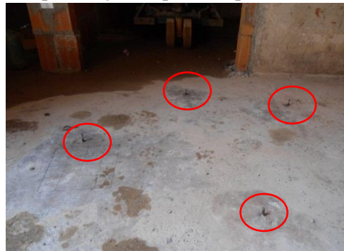
Ensaio de penetração de pino em laje e parede de concreto
