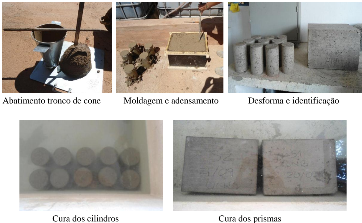
Figura 3.2- Moldagem e cura dos corpos de prova cilíndricos e prismáticos.
