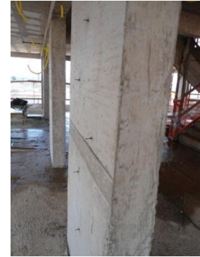
Ensaio de penetração de pino em pilares e medição do comprimento exposto
