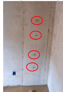
Ensaio de penetração de pino em laje e parede de concreto
