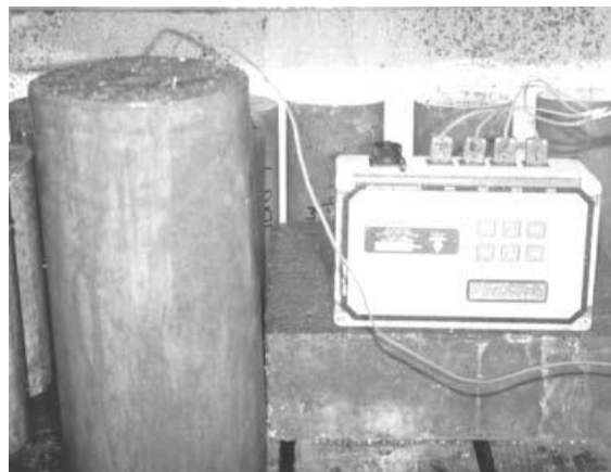
Figura 2.9- Cilindro de concreto instrumentado com o medidor de maturidade e submetidos a cura úmida padrão (MALHOTRA, 2004).
