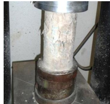
Ruptura do Corpo de prova
