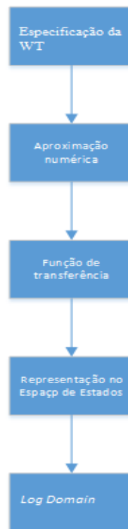
Figura 4-1: Fluxo de projeto do filtro da Wavelet.
