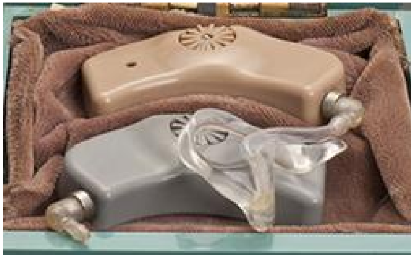
Figura 2-6: Primeiro aparelho auditivo BTE [24].
