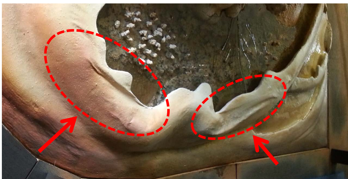
FIGURA 5-26. Detalhe de áreas de isopor derretidas pela liberação de calor durante o processo de cura da resina de poliéster.
