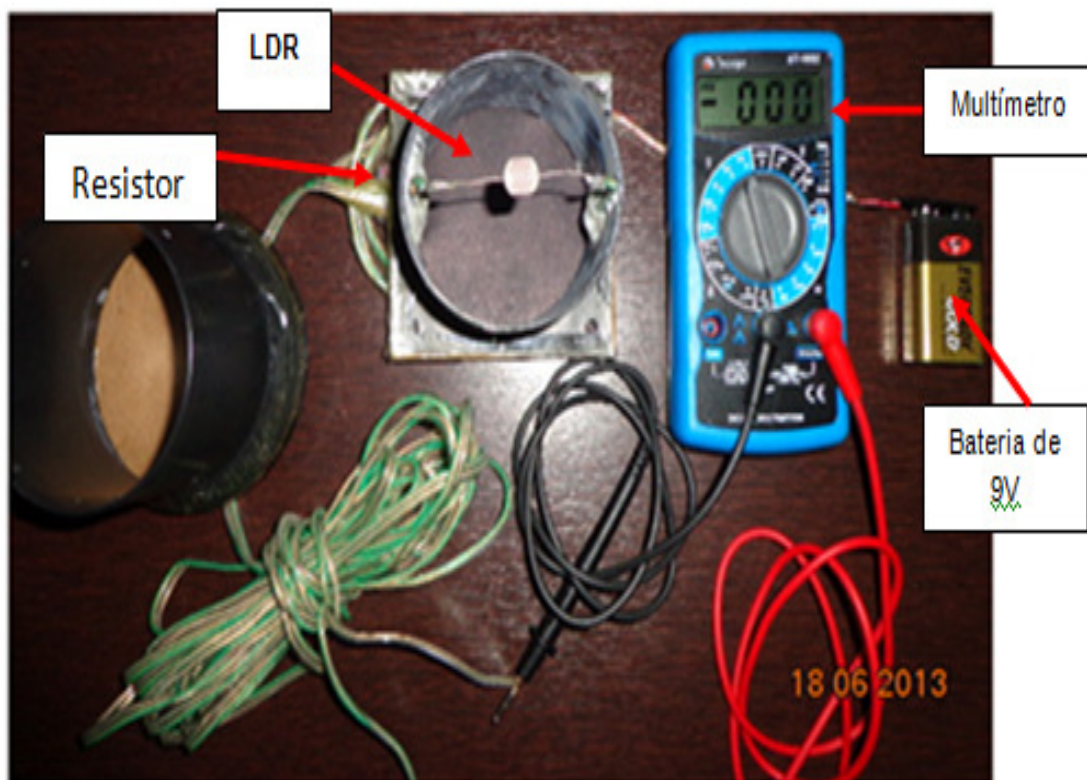
Figura 18: Foto do sensor após montagem.
