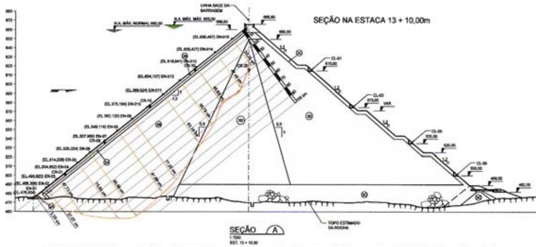
Figura 2.9 – Deflexão da laje no Leito do rio – L-17 (Sobrinho et al., 2007).
