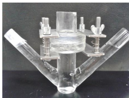
Figura 11. Célula de difusão do tipo Franz modificada montada para realização dos estudos in vitro de liberação.
