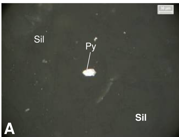
Prancha LUSL-01 – Opacos – A) cristal de pirita (Py) com início de oxidação para limonita (cinza); B) limonita (Lm) substituindo pirita (Py). Obj. a óleo. Luz natural.
