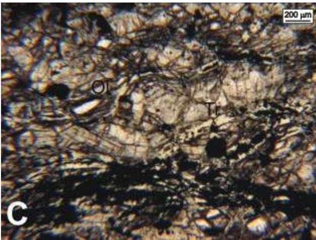
Prancha FD26 – 79,85 m – C e D) mostrando a anisotropia estrutural da rocha, marcada pelo anastomosamento da foliação, marcada por cristais de tremolita e antigos cristais de olivina. Luz natural e luz polarizada, respectivamente.
