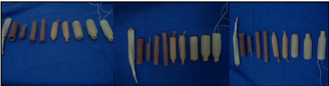
Figura A.9 - Fotografia da evolução do módulo CFE – da esquerda para direita – primeiro feito de material cirúrgico e o último feito de látex.
