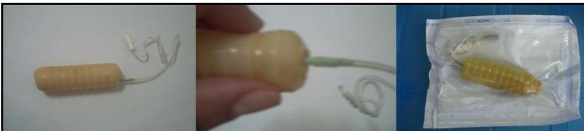
Figura A.6 - Fotografia do módulo com melhorias construtivas e ranhuras circulares, desenvolvido em novembro de 2007.
