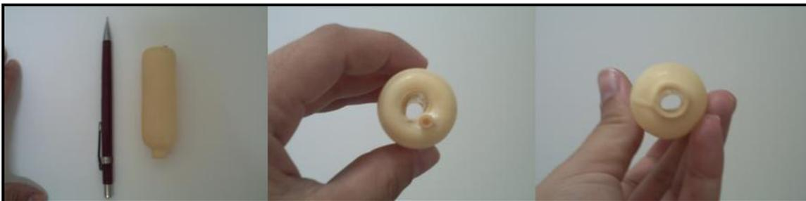
Figura A.5 - Fotografia do módulo feito a base de látex, vulcanizado em estufa, e utilizando válvula desenvolvida, confeccionado em outubro de 2007.
