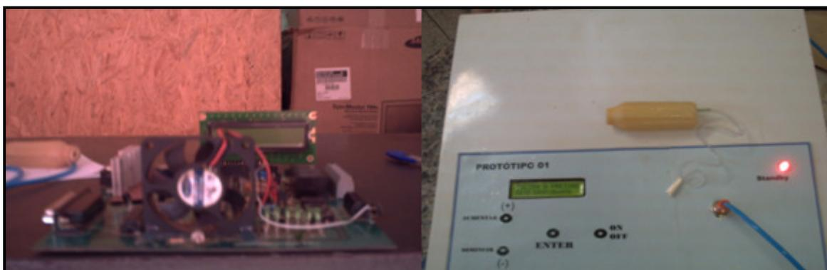
Figura 4.2 - Fotografia da placa do circuito e do equipamento que realiza o enchimento do módulo CFE.
