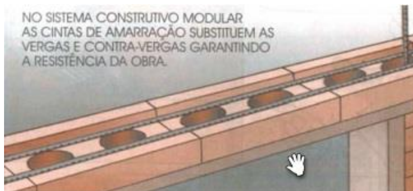
Figura 8 – Detalhe das cintas de amarração e das contra-vergas Fonte: Grupo Aguilar – SAHARA.
