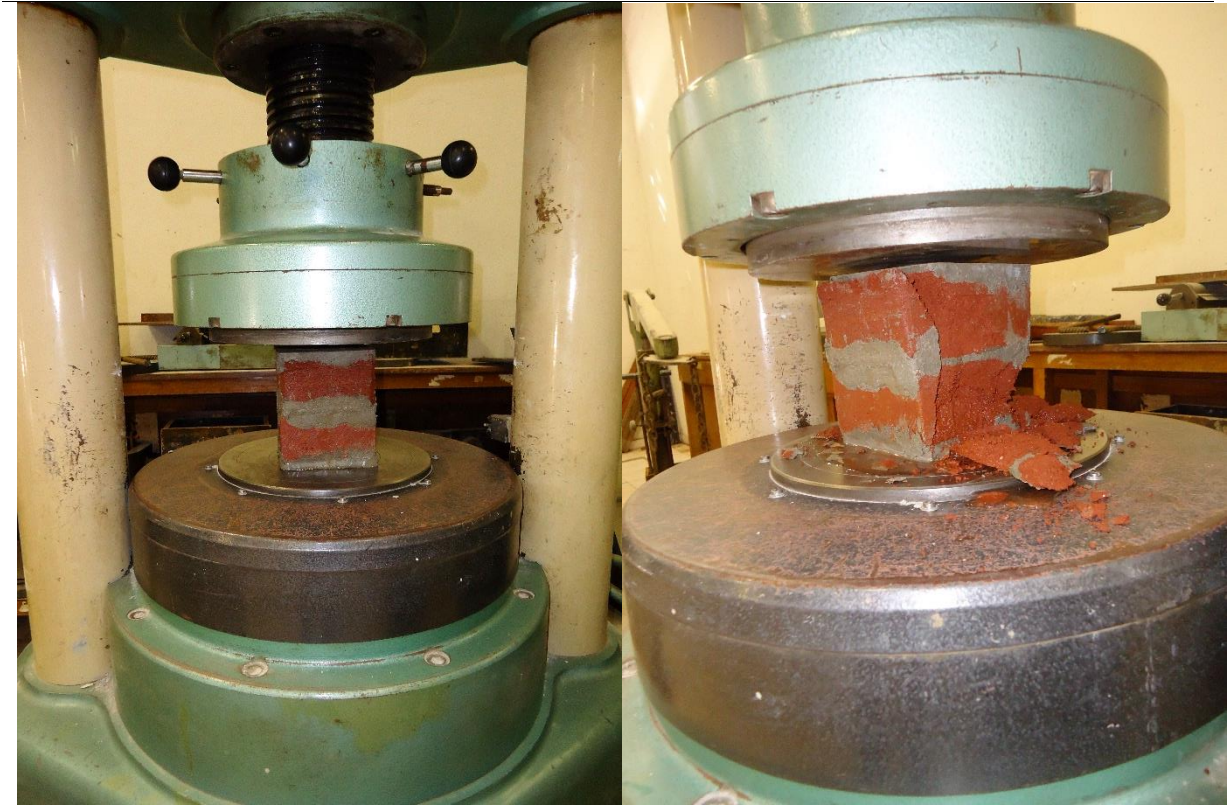
Fig. 3.13 - Primas antes da ruptura (esq.); Primas depois do rompimento (dir.)
