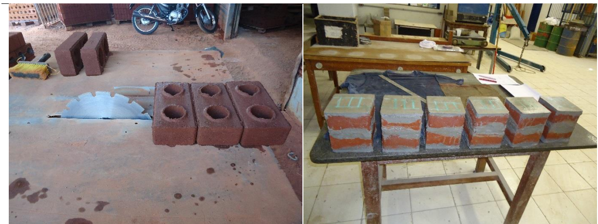
Fig. 3.12 - Blocos a serem serrados ao meio (esq.); Prisms após o capeamento (dir.)
