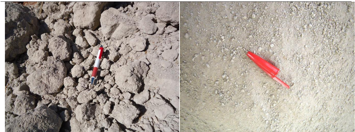
Fig. 3.7 - Resíduo de argamassa antes e depois da britagem
